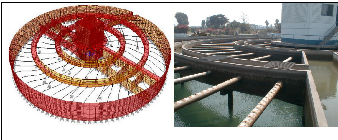
Figura 554. Idealización matemática del decantador
