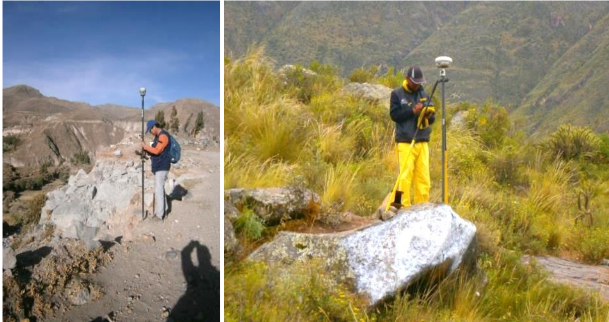
Figura 6. Método de medición mediante el sistema RTK sobre los puntos de monitoreo temporal.
