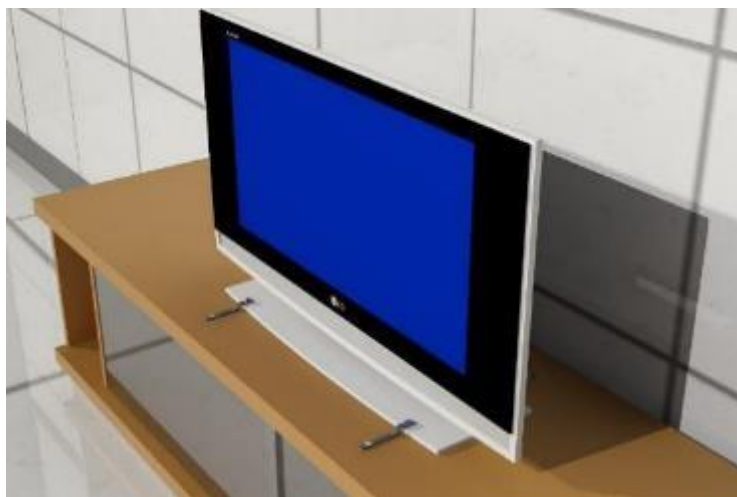
Figura 80: Formas de asegurar equipos electrónicos, mediante seguros de correas.
