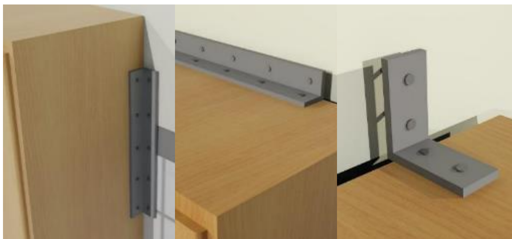
Figura 79: Los sistemas de aseguración pueden ser de diferentes tipos, en las zonas laterales o parte superior, el objetivo es contar con puntos de sujeción ante volcamientos o caídas.
