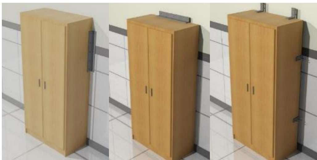
Figura 78: Muebles y armarios deben estar fijados y asegurados afín de evitar caídas que afecten al personal de salud o que obstruyan salidas o corredores de evacuación.
