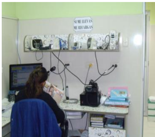
Foto 29: Equipos de Tópicos de Urgencias apoyados en repisas de madera que permiten un desplazamiento en caso de movimiento sísmico.
