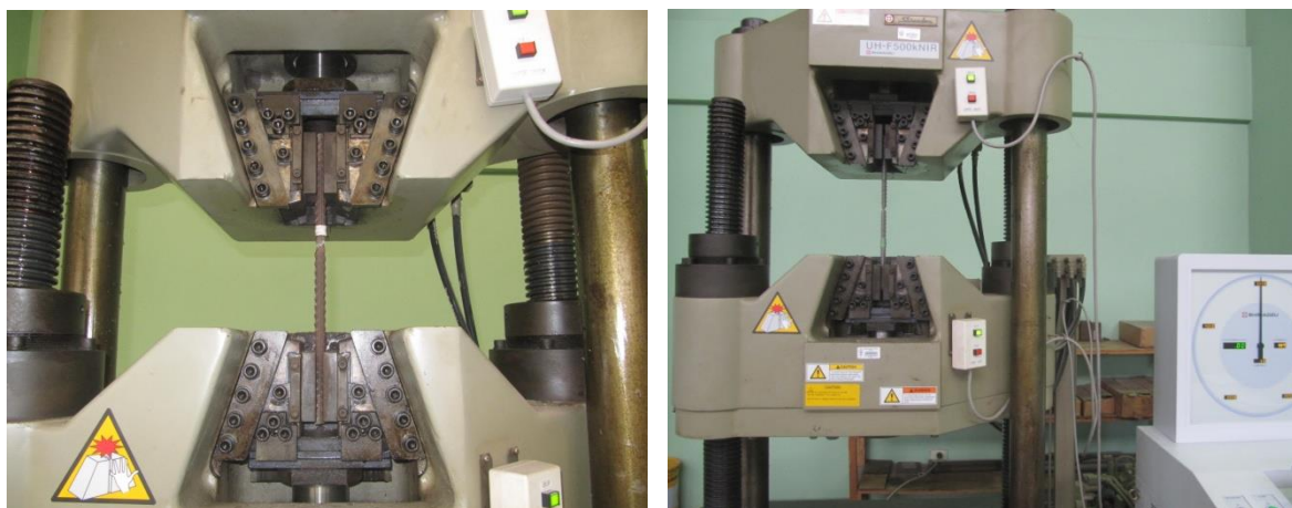
Foto 16 Ensayo de tracción de muestras de acero.
