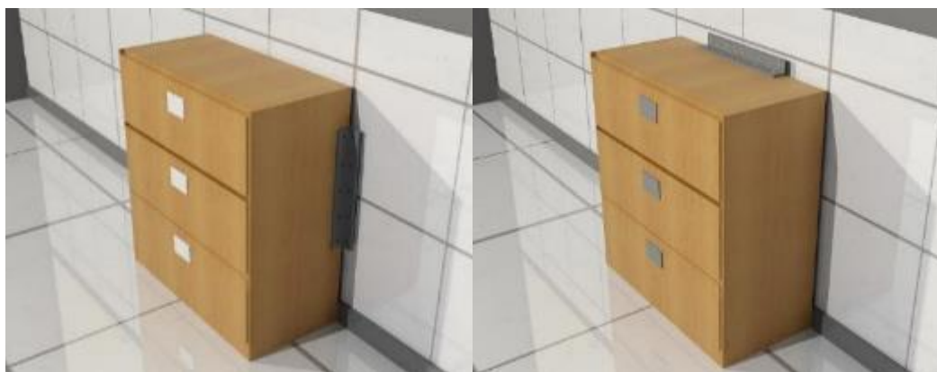
Figura 77: Archivadores deben estar asegurados y evitar caídas que obstruyan salidas o corredores de evacuación. .
