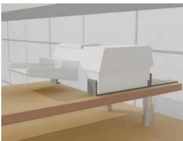
Figura 76: Equipos como impresoras deben estar sujetos a asegurados para evitar su desplazamiento ante movimientos sísmicos.
