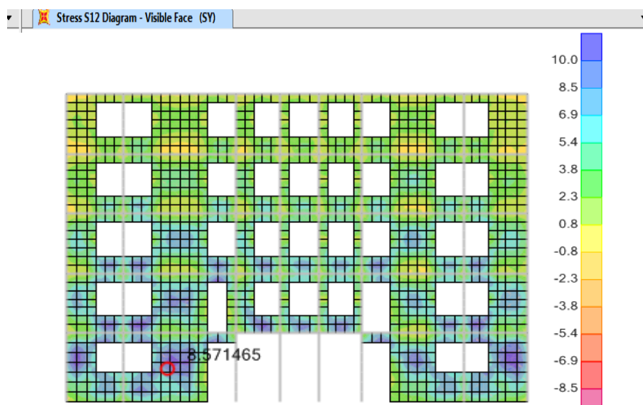
Figura 59: Esfuerzos cortantes ( \text{kg}/\text{cm}^2 ) en los muros de albañilería en dirección "Y" del Bloque A-Vista lateral.
