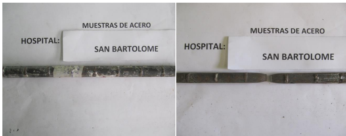
Foto 15 Muestras de acero, antes y después del ensayo de tracción.
