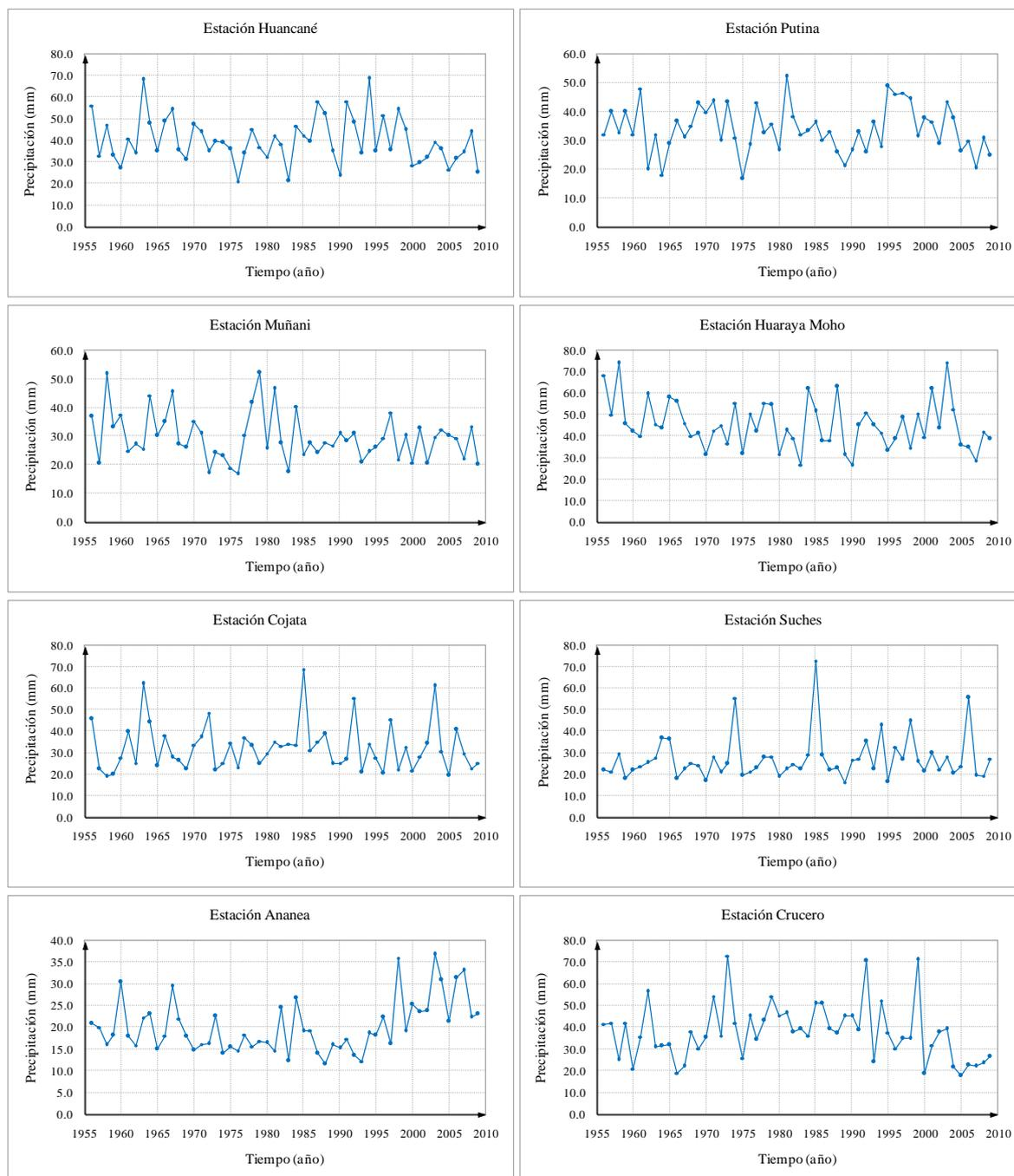
Para el análisis de frecuencia de la precipitación máxima en 24 horas, se ha empleado el Software Hidrológico de Eventos Extremos FLFREQ, es un programa que permite calcular la precipitación máxima en 24 horas para diferentes períodos de retorno, considerando las funciones de distribución de probabilidades de LogNormal de 2 parámetros, LogNormal de 3 parámetros, Gumbel I y LogPearson III.
