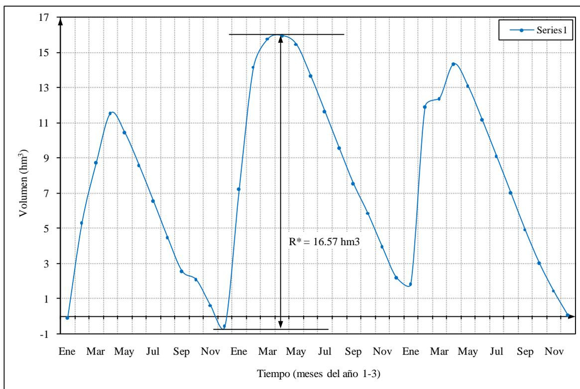
En el Cuadro N° 12.2 se muestran el resumen de capacidades de embalse calculados por el método experimental – rango ajustado, empleando las series de caudales medios mensuales generados por el modelo hidrológico de Lutz Scholz y el modelo estocástico Markoviano de series mensuales, en el río Guanaco (Embalse Callatomaza) y río Yaputira (Embalse Yaputira).
