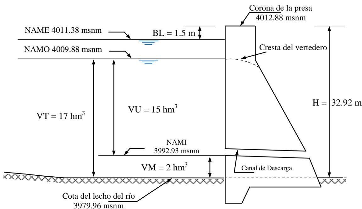
En presas de regulación de agua para irrigaciones, el NAMI (nivel de aguas mínimas de operación) es el nivel más bajo con el que puede operar la presa y coincide con el nivel al que se encuentra la entrada del canal de descarga (toma). En el caso de presas para generación de energía eléctrica, el NAMI vendría ser NAMINO (nivel de aguas mínimas de operación) se fija de acuerdo con la carga mínima necesaria para que las turbinas operen en condiciones óptimas.
