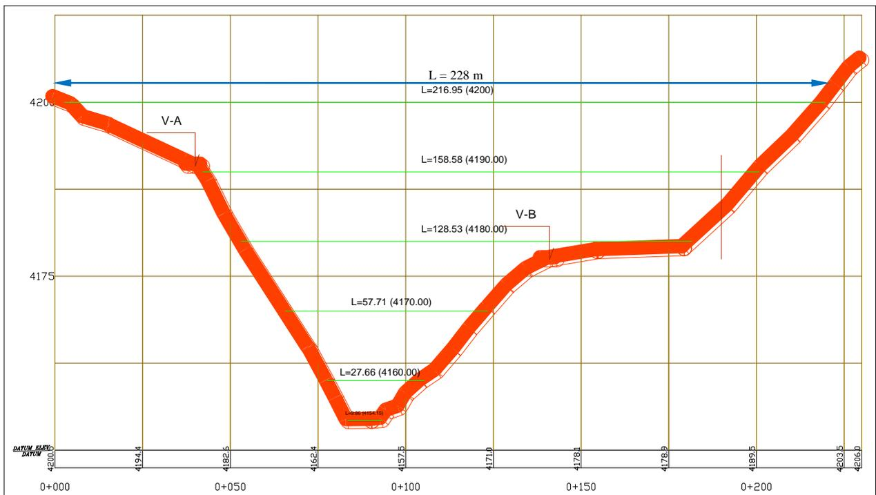
Figura N° 12.8 Sección transversal del eje de presa Yapurita
