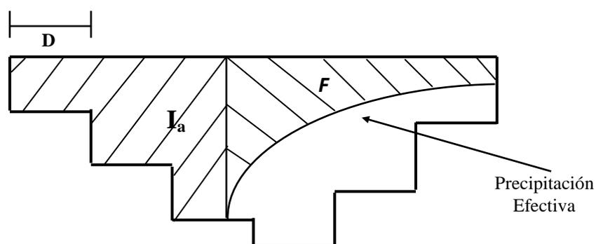
Figura N° 11.4 Variables del método SCS para abstracciones.
