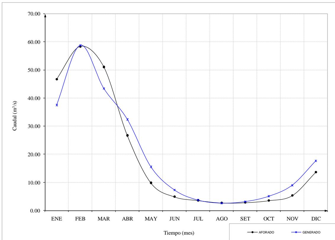
A continuación se muestra la comparación de hidrogramas de precipitación mensual, precipitación efectiva y escorrentías generadas y aforadas, con el fin conocer el comportamiento de los mismos.
