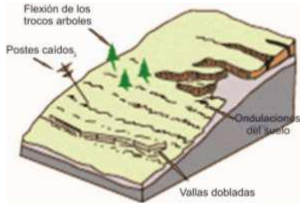
Figura N° 5: Esquema de reptación de suelos (Cruden y Varnes, 1996).
