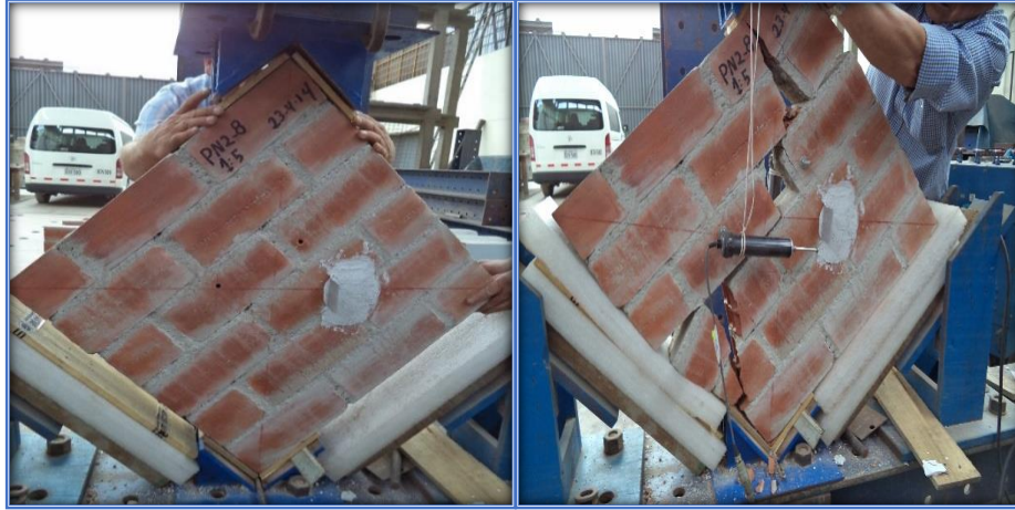
Fig. N° 30. PND2 - 15 - M8 - Falla ladrillo diagonal superior y deslizamiento ladrillo mortero
