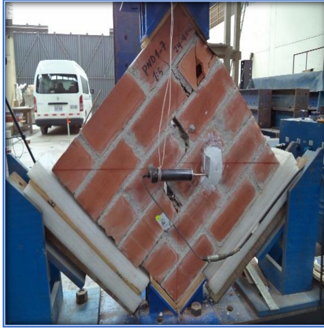
Fig. Nº 20. PND1 - 15 – M7 - Deslizamiento a lo largo de la diagonal
