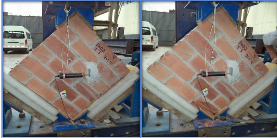
Fig. Nº 9. PND2 - 13 – M4 - Falla local ladrillo extremo diagonal inferior
