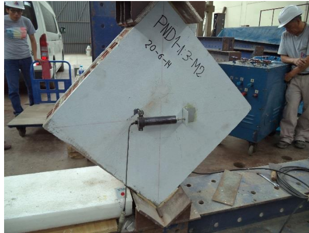
Fig. Nº 37. PND1 - 13 - M02 – Ensayo de compresión
