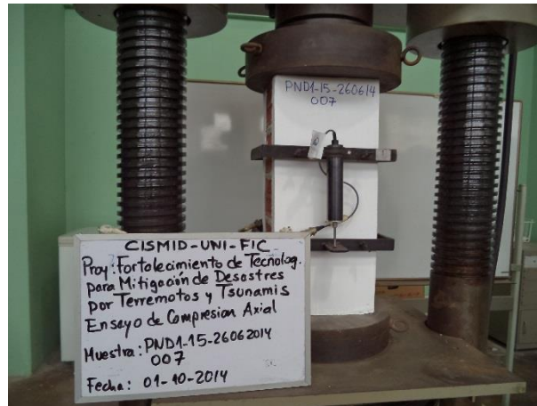
Fig. N° 42. PND1 - 15 – P07 – Ensayo de compresión
