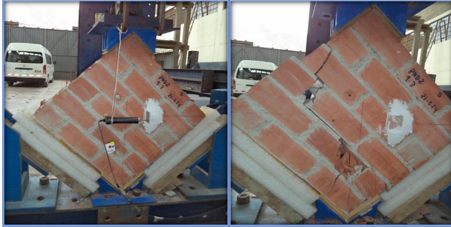
Fig. Nº 10. PND2 - 13 - M5 - Falla local ladrillo diagonal inferior y deslizamiento mortero
