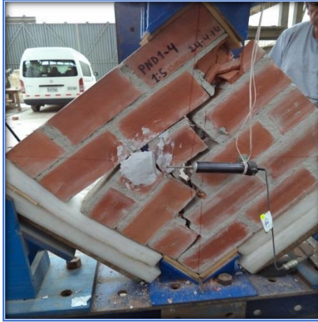
Fig. Nº 17. PND1 - 15 – M4 - Falla deslizamiento mortero ladrillo
