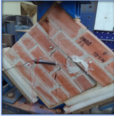
Fig. Nº 6. PND1 - 13 – M8 - Deslizamiento mortero ladrillo y pequeña falla en diagonal ladrillo
