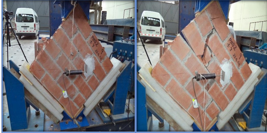
Fig. N° 14. PND2 - 13 – M9 - Falla ladrillo diagonal superior y deslizamiento en la diagonal
