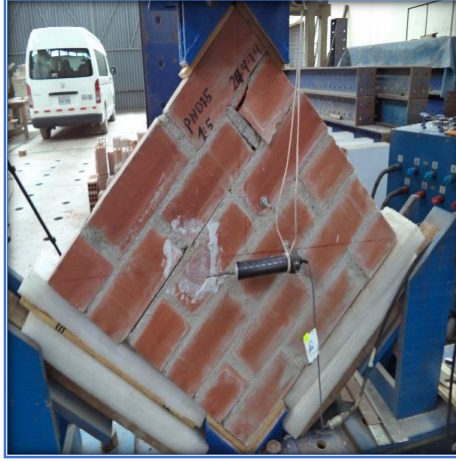
Fig. Nº 18. PND1 - 15 – M5 - Falla deslizamiento mortero ladrillo
