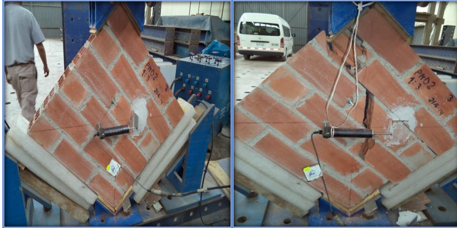
Fig. Nº 8. PND2 - 13 – M3 - Falla ladrillo centro de diagonal y local extremo diagonal superior
