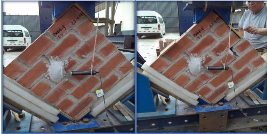
Fig. Nº 16. PND1 - 15 - M3 - Falló mortero deslizamiento
