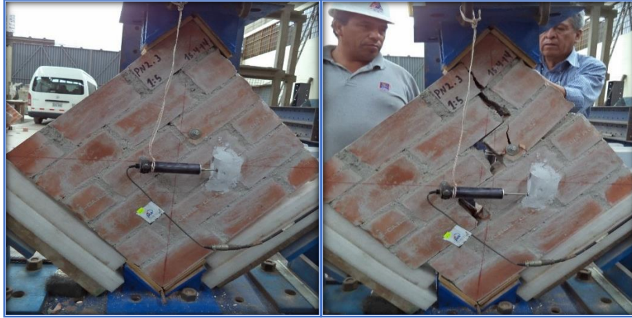
Fig. N° 25. PND2 - 15 – M3 - Deslizamiento y falla diagonal
