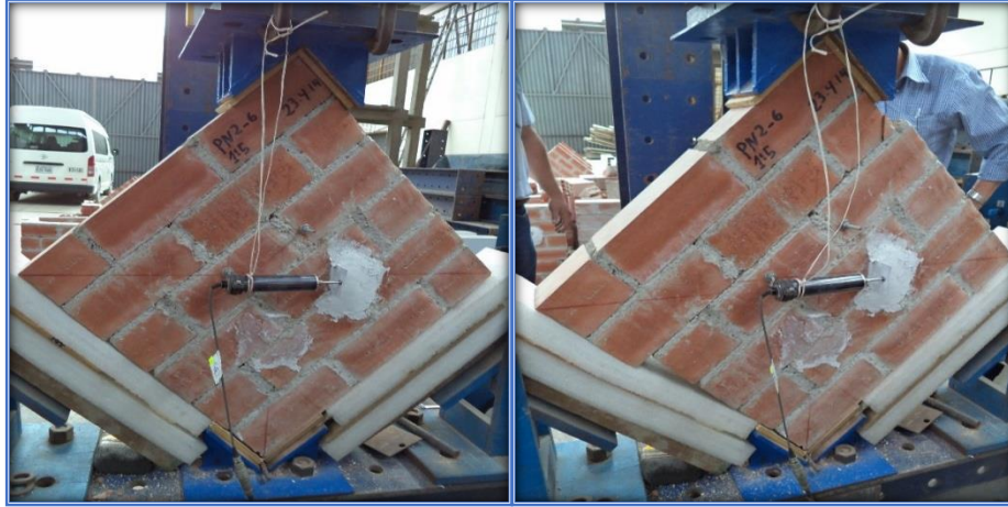
Fig. N° 28. PND2 - 15 – M6 - Falla por deslizamiento mortero ladrillo
