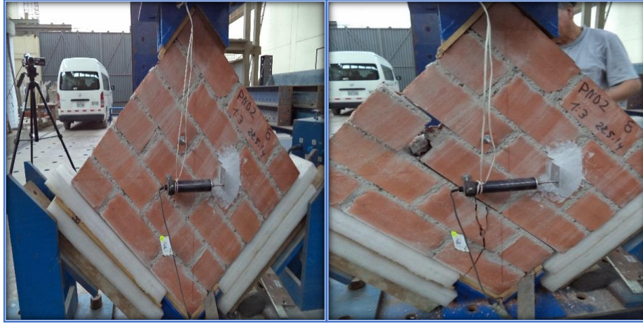
Fig. Nº 13. PND2 - 13 – M8 - Deslizamiento mortero ladrillo y falla ladrillo diagonal inferior
