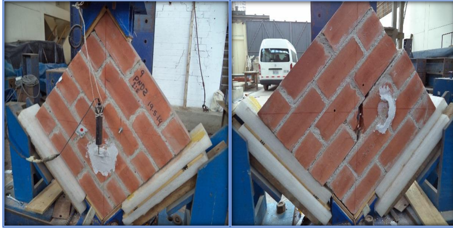
Fig. Nº 31. PND2 - 15 – M9 - Falla ladrillo centro de diagonal y deslizamiento mortero ladrillo
