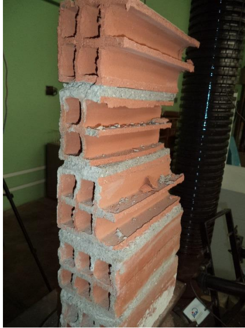
Fig. Nº 35. PND2- 15 – P05 – Ensayo de compresión
