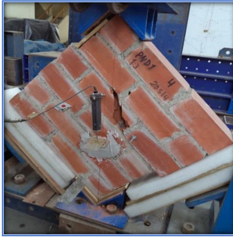
Fig. Nº 3. PND1 - 13 – M4 - Falla primero ladrillo diagonal superior
