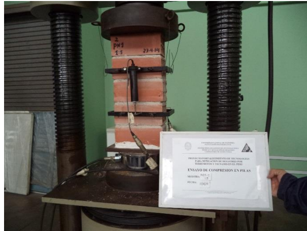
Fig. N° 33. PND1 - 15 – P02 – Ensayo de compresión
