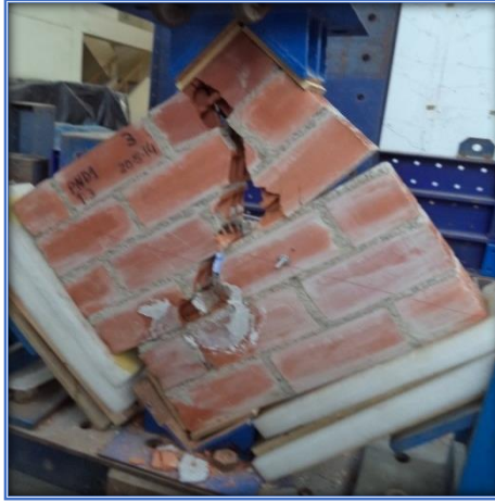
Fig. Nº 2. PND1 - 13 - M3 - Falla ladrillo diagonal superior y deslizamiento mortero ladrillo
