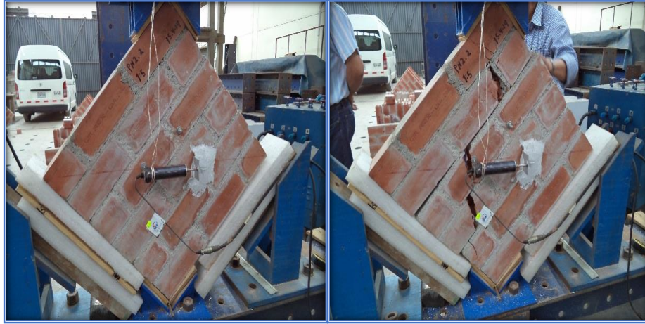
Fig. N° 24. PND2 - 15 – M2 - Falla local de ladrillo arriba y rotura fuera de la diagonal
