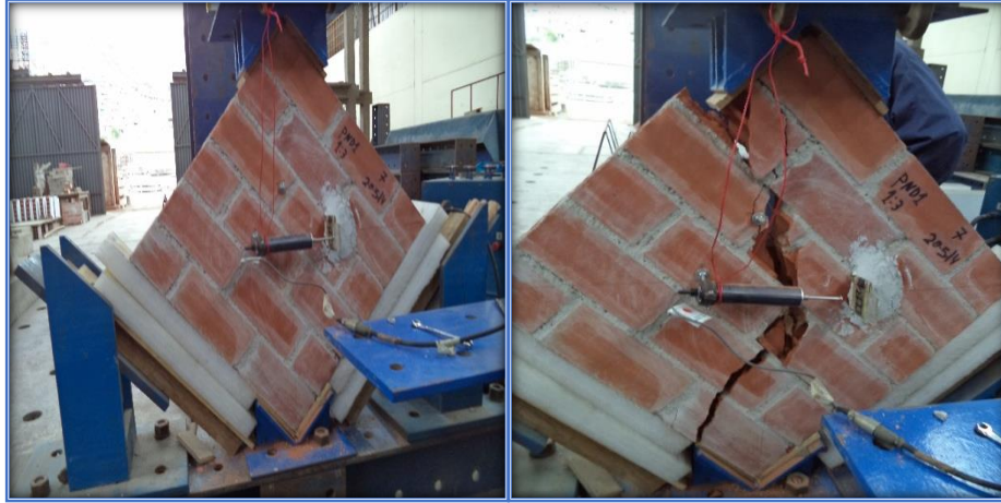
Fig. Nº 5. PND1 - 13 - M7 - Falla a lo largo de la diagonal
