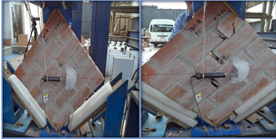
Fig. N° 26. PND2 - 15 - M4 - Deslizamiento y falla diagonal
