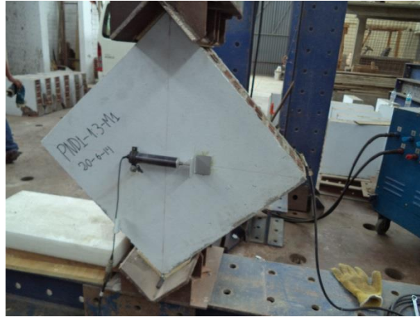
Fig. N° 36. PND1- 15 – M01 – Ensayo de compresión
