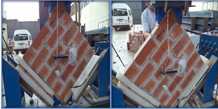
Fig. Nº 19. PND1 - 15 – M6 - Falla deslizamiento mortero ladrillo
