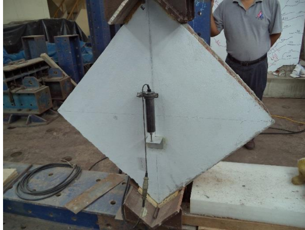
Fig. N° 38. PND1 - 15 – M1 – Ensayo de compresión
