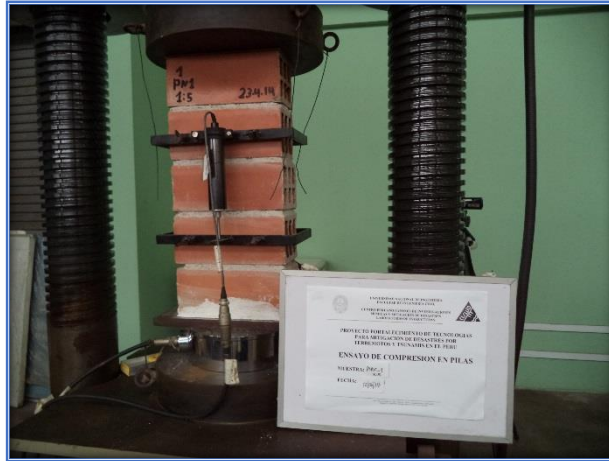
Fig. Nº 32. PND1 - 15 – P01 – Ensayo de compresión
