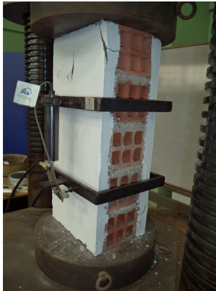
Fig. N° 40. PND1 - 15 – P02– Ensayo de compresión
