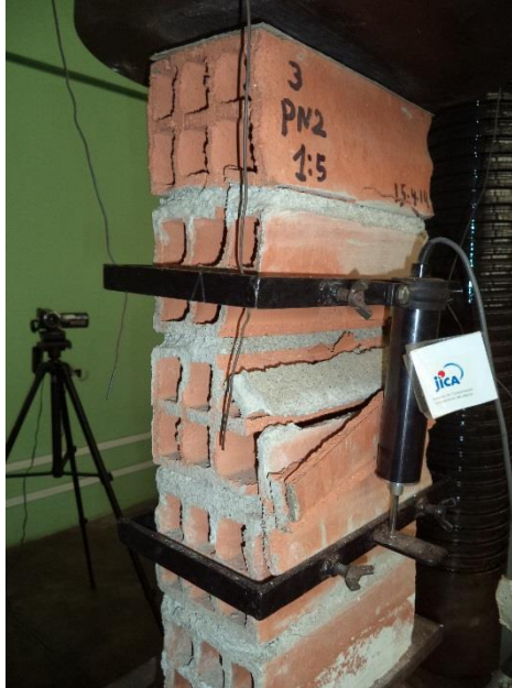
Fig. N° 34. PND2- 15 – P03 – Ensayo de compresión
