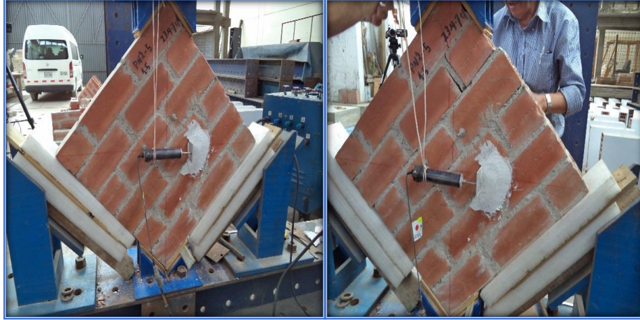
Fig. N° 27. PND2 - 15 - M5 - Falla por deslizamiento mortero ladrillo
