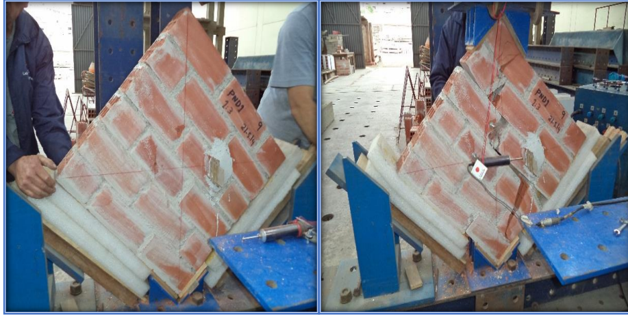
Fig. N° 7. PND1 - 13 – M9 - Falla ladrillo diagonal superior e inferior, deslizamiento mortero ladrillo
