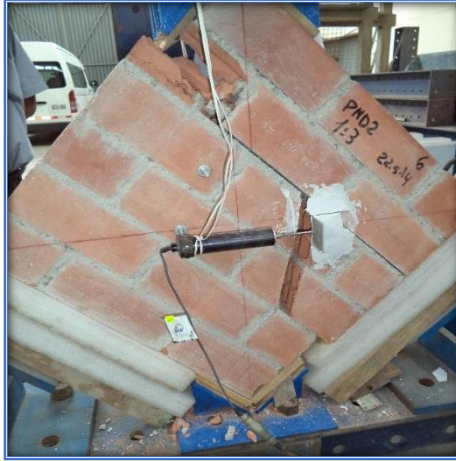
Fig. Nº 11. PND2 - 13 – M6 - Primero falló ladrillo superior diagonal
