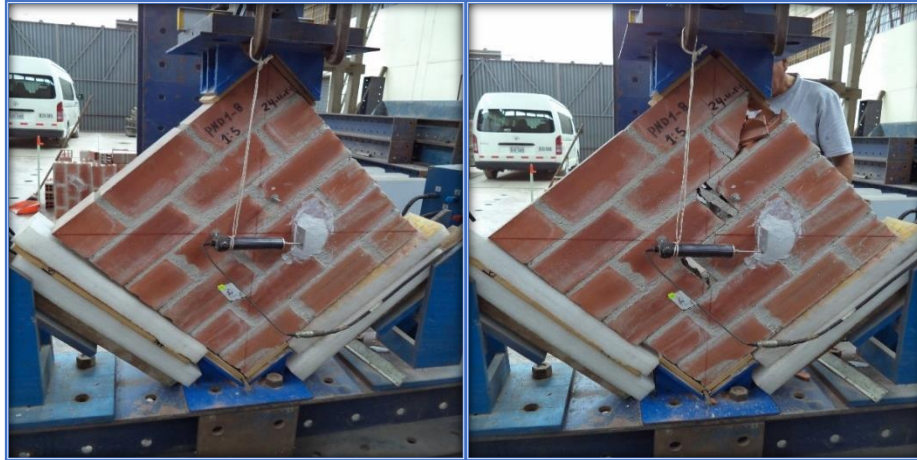
Fig. Nº 21. PND1 - 15 – M8 - Deslizamiento a lo largo de la diagonal
