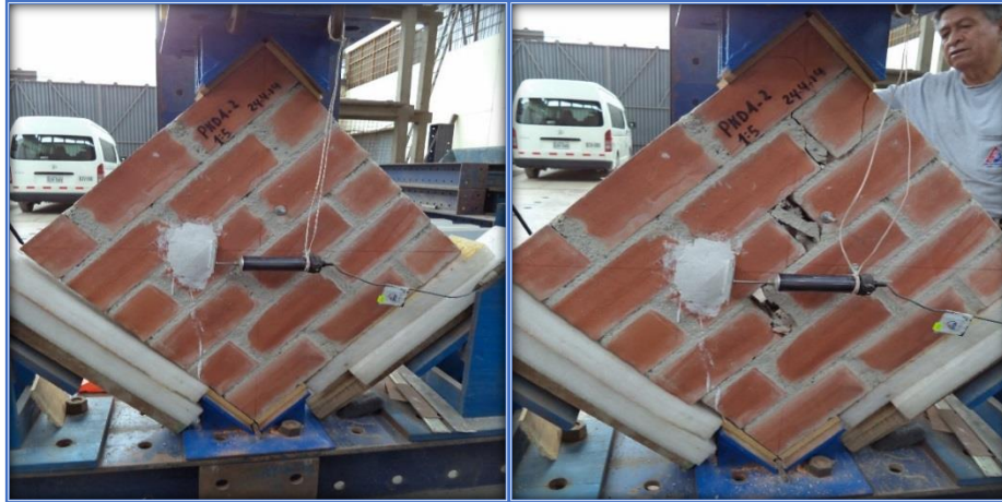
Fig. Nº 15. PND1 - 15 – M2 - Falló mortero deslizamiento
