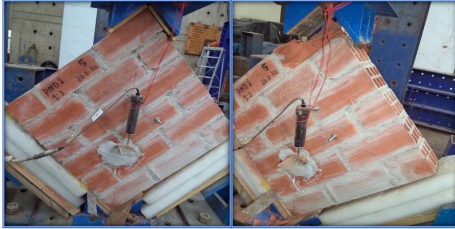
Fig. Nº 4. PND1 - 13 – M5 - Falla local en ladrillo extremo diagonal superior
