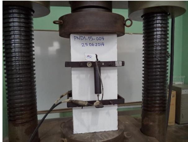
Fig. Nº 41. PND1 - 15 – P04 – Ensayo de compresión
