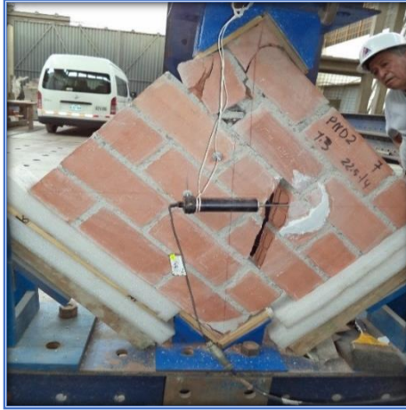
Fig. Nº 12. PND2 - 13 – M7 - Falla local ladrillo diagonal superior y deslizamiento mortero
