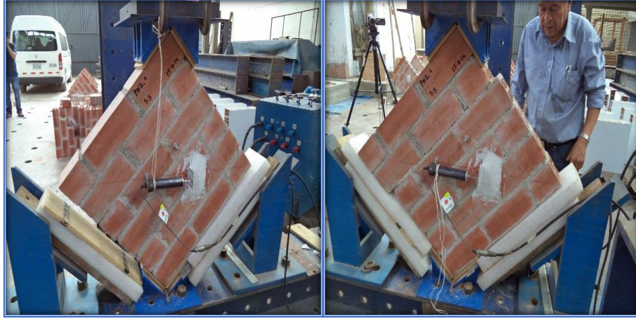
Fig. Nº 23. PND2 - 15 - M1 - Falla deslizamiento mortero ladrillo
