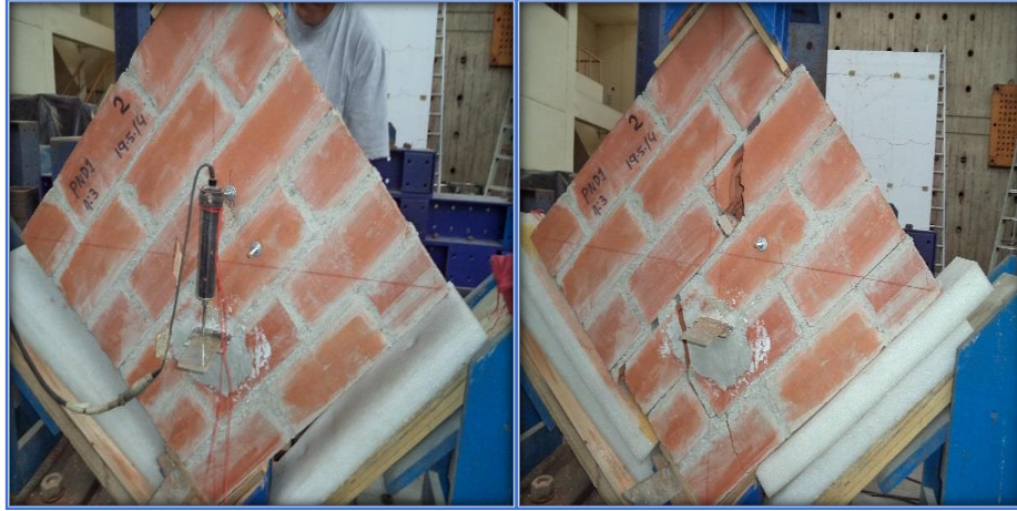
Fig. Nº 1. PND1 - 13 - M2 - Falla ladrillo diagonal superior y deslizamiento mortero ladrillo
