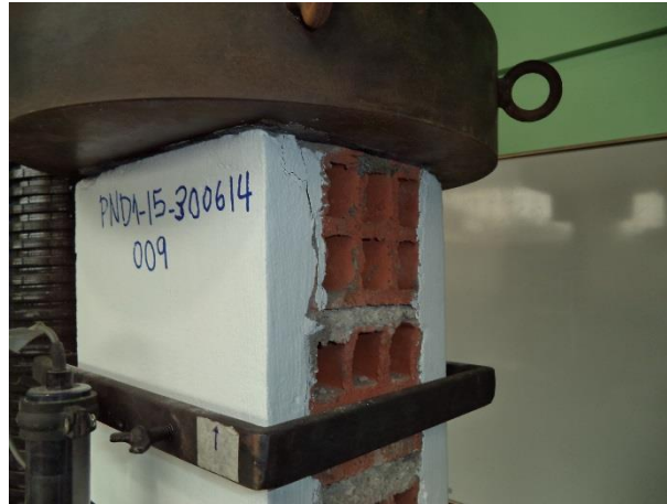
Fig. N° 43. PND1 - 15 P09 -Ensayo de compresión
