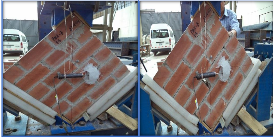
Fig. N° 29. PND2 - 15 – M7 - Falla por deslizamiento mortero ladrillo
