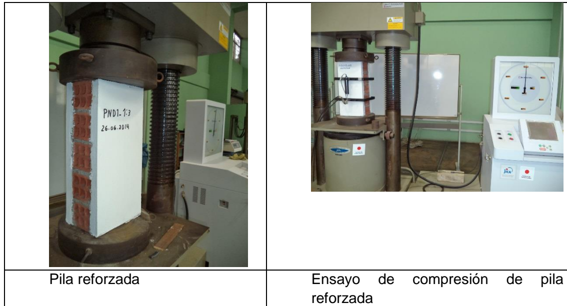
Figura 16 Ensayo de pilas reforzadas
