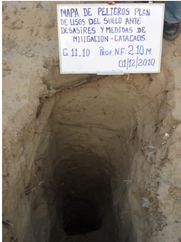
Calicata 11 - 10 Ubicado en la parte posterior del Centro Poblado La Legua
