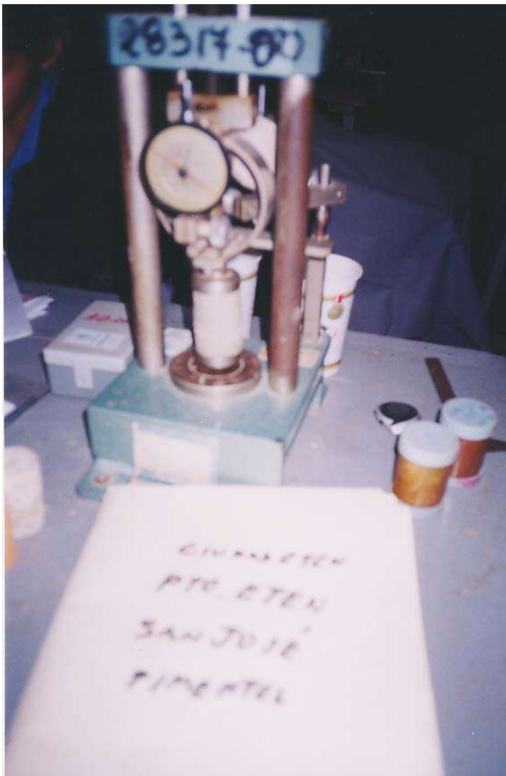
Ensayo de compresión simple
