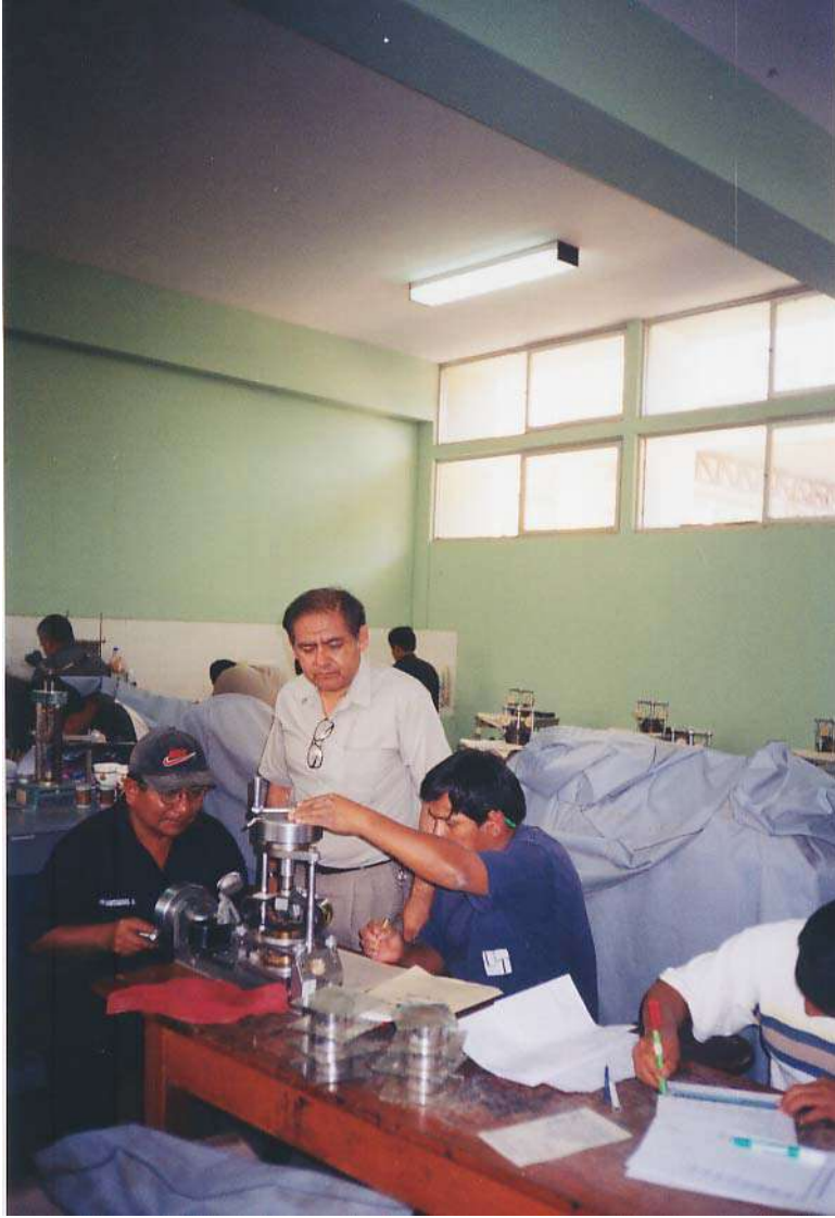
Supervisión del ensayo de corte directo.
