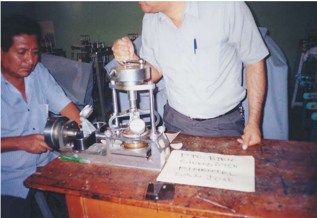
Preparación del Ensayo de corte directo
