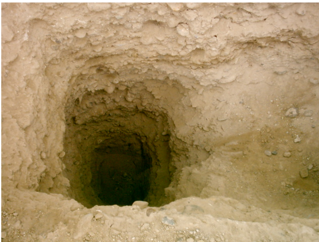
Fotografía N° 54. Calicata C-15 excavada en la Asociación de Vivienda ADUS y que muestra un suelo gravo arcilloso con gravas subredondeadas y tamaño máximo de 10.0 cm y que se encuentra en estado de compacidad Medio a Denso.
