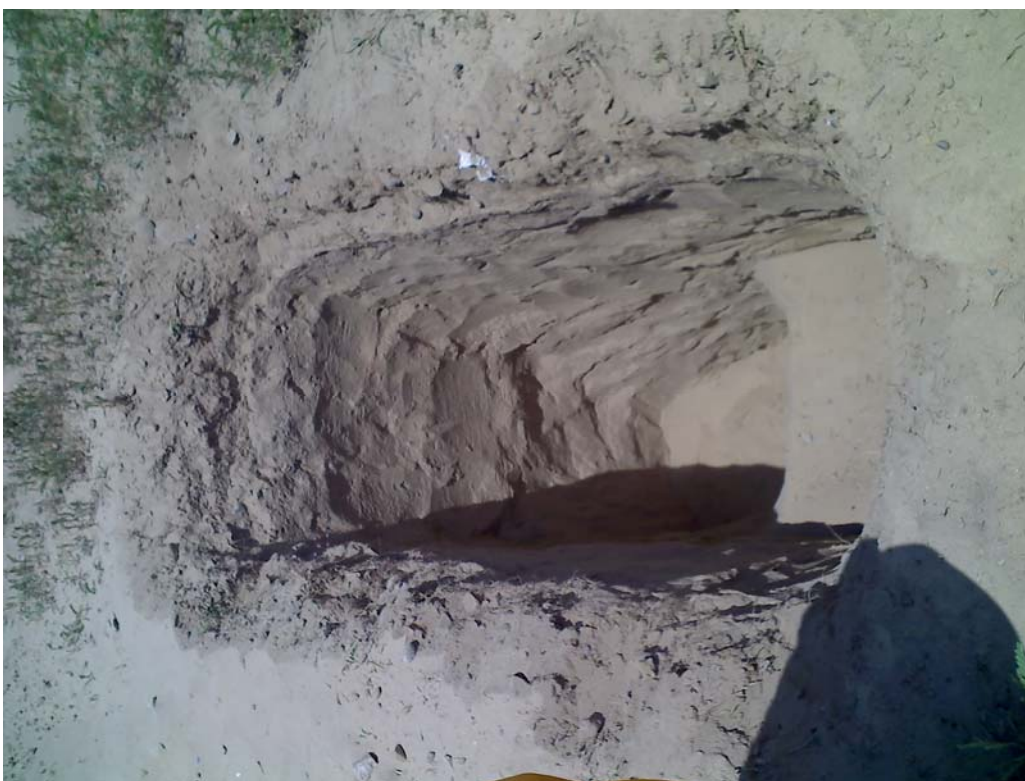
Fotografía N° 48. En la Calicata C12 el suelo es arenoso pobremente graduado de color beige claro, en estado de compacidad Suelto. No se ha encontrado el nivel freático.
