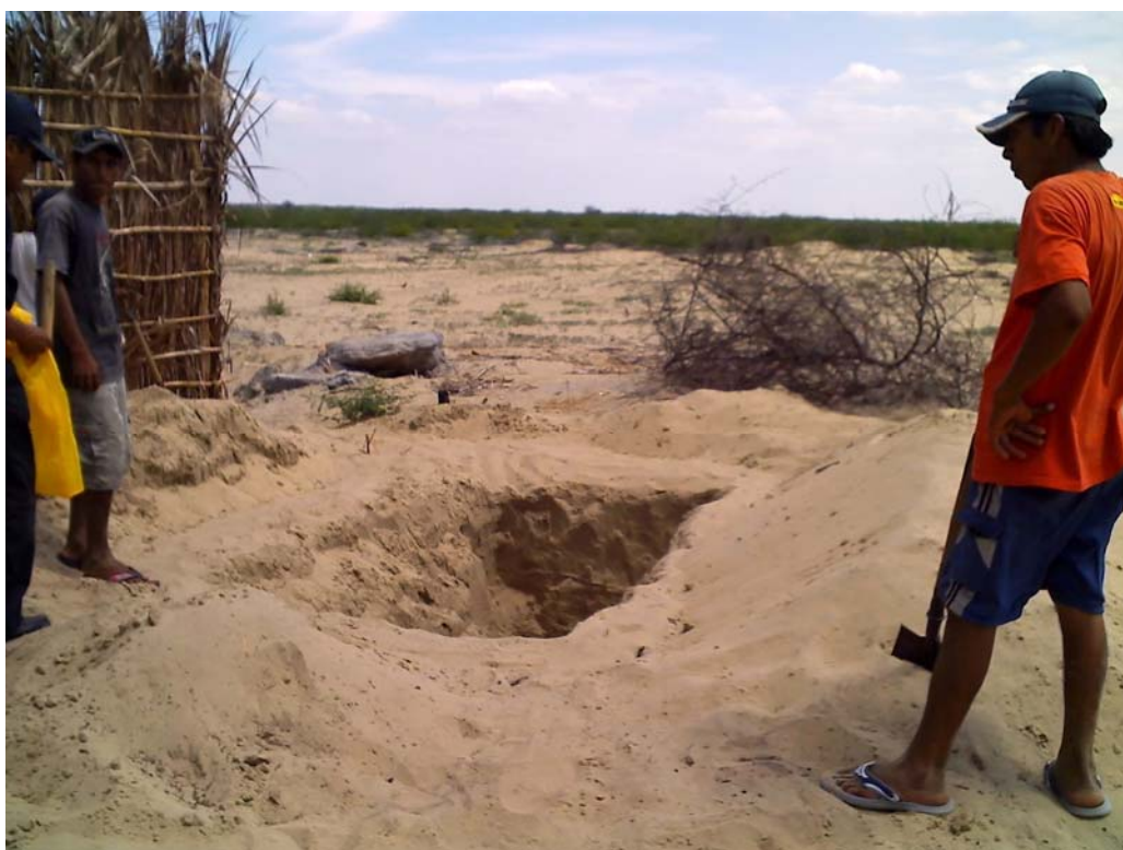
Fotografía N° 49. Calicata C-13 excavada en la Urb. Popular Jaime Bardales ubicada en la parte posterior del local de la Universidad Nacional de Piura. Se trata de un suelo de origen eólico.
