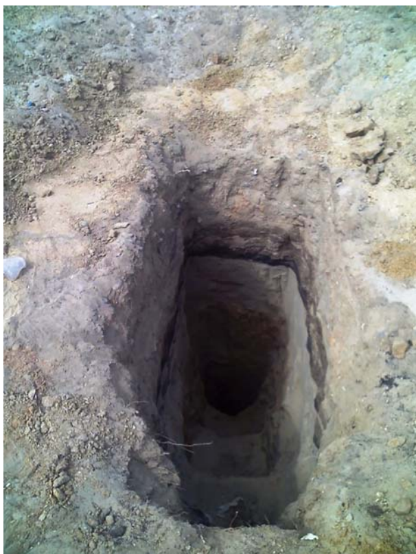
Fotografía N° 44. Calicata C-01 en cuyo interior es posible apreciar incrustaciones blanquecinas que no es otra cosa que los carbonatos de calcio presentes en el suelo. El peso volumétrico de este suelo es bajo, pero se muestra muy compacto en estado seco y con presencia de agua se vuelven inestables y es probable que tengan algún comportamiento colapsable si es que el contenido de sales es mayor a 15,000 p.p.m.
