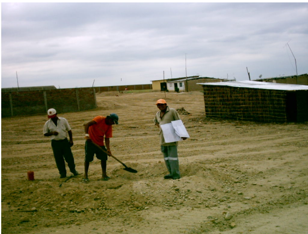
Fotografía N° 53. Calicata C-15 excavada frente a la Asociación de Vivienda ADUS ubicada en la zona sur de la ciudad de Sullana. Se trata de un suelo de origen fluvio-aluvional conformado por grava arcillosa con arena.
