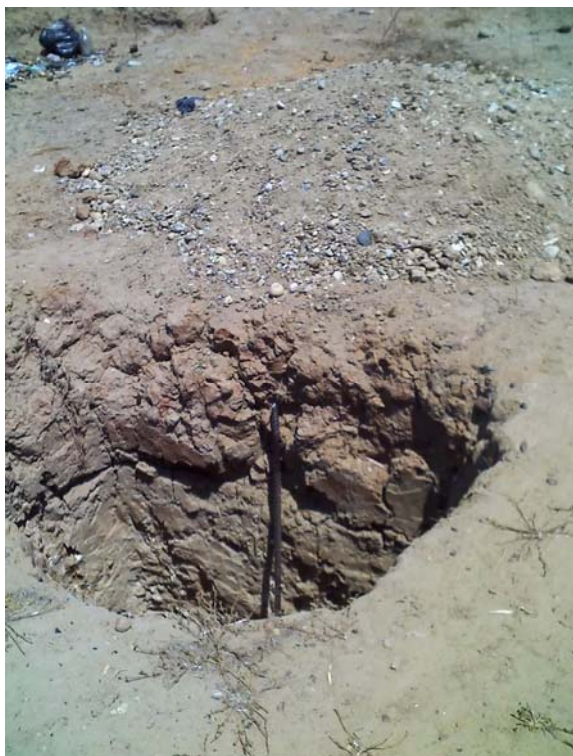
Fotografía N° 42. Calicata C-06 ubicada en la zona Sur-Oeste de la ciudad de Sullana en el límite con Tambogrande en el AA HH Villa María en donde se aprecia que el material conglomerado es cubierto por un suelo del tipo areno-arcilloso con un gran contenido de carbonatos de calcio con una potencia variable en este Sector, que va desde 0.50 m. hasta 1.50 m. A continuación de este suelo se encuentra el material gravo-areno-arcilloso fuertemente cementado y de compacidad Media a
