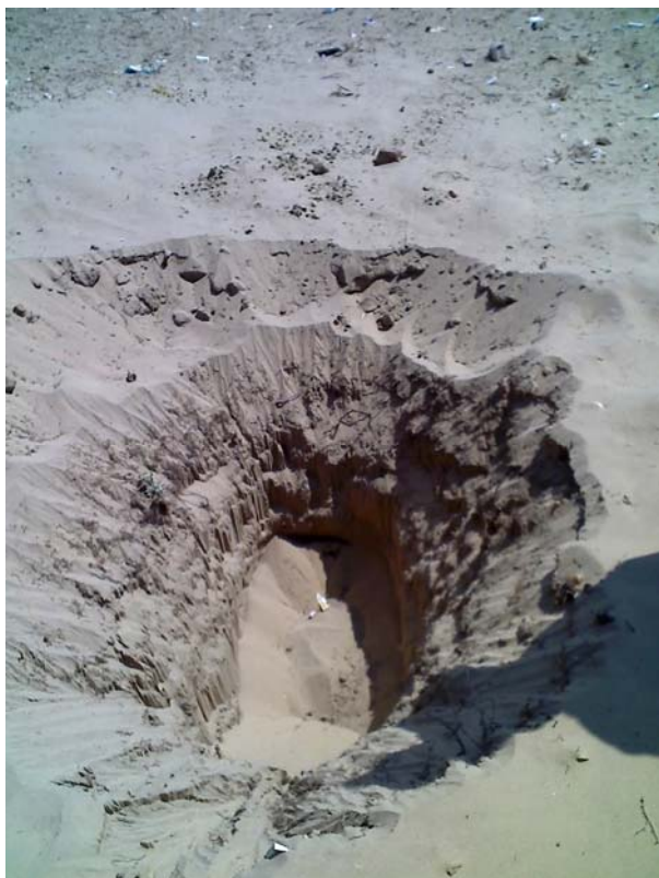
Fotografía N° 40. Calicata C-09 donde aprecia claramente el suelo arenoso de color gris claro, de granos muy finos y de gradación uniforme.
