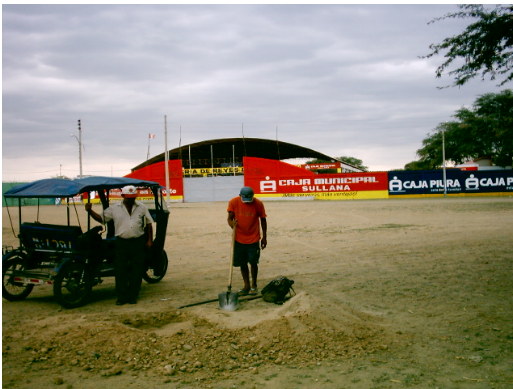
Fotografía N° 51. Calicata C-14 excavada frente al Campo Ferial de los Reyes ubicada en la carretera con salida hacia la ciudad de Piura. Se trata de un suelo de origen fluvio-aluvional conformado por arcilla arenosa con gravas.
