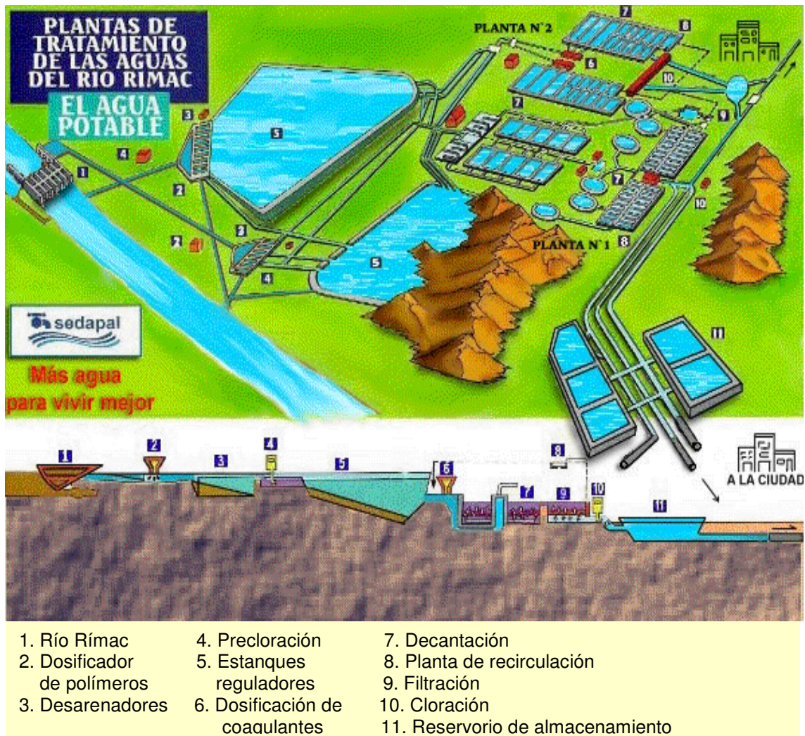
Figura 94. Esquema de la planta de tratamiento de la Atarjea
