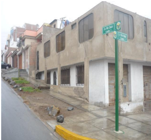
Figura 55. Calles inclinadas debido a pendientes del terreno que influyen en la altura de primeros pisos de construcciones.
