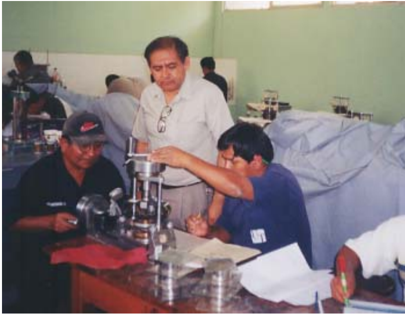
Foto Nro. E7. Supervisión del ensayo de corte directo.
