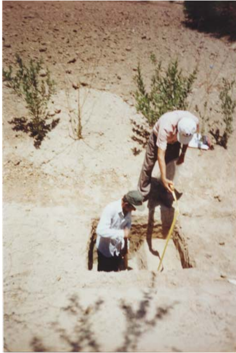
Foto Nro. 3. Calicata C-3 y medición de estratos.
