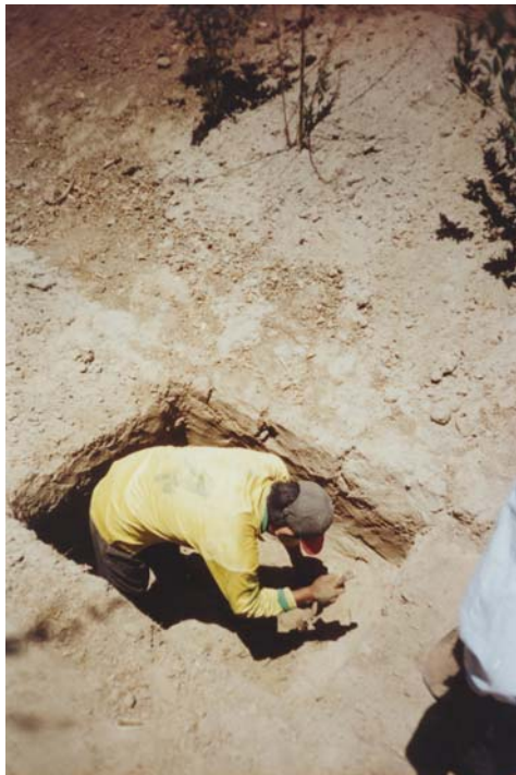
Foto Nro. 4. Extracción de muestras inalteradas en calicata C-3.
