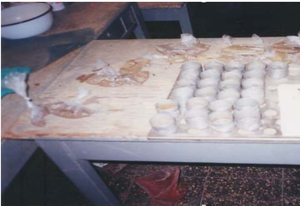
Foto Nro. E4. Ensayo de contenido de humedad.
