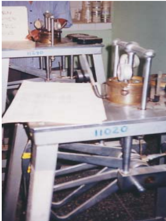
Foto Nro. E7. Supervisión del ensayo de corte directo.
