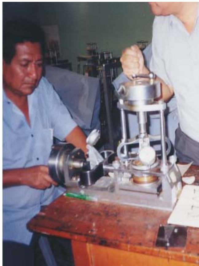
Foto Nro. E6. Preparación del Ensayo de corte directo.
