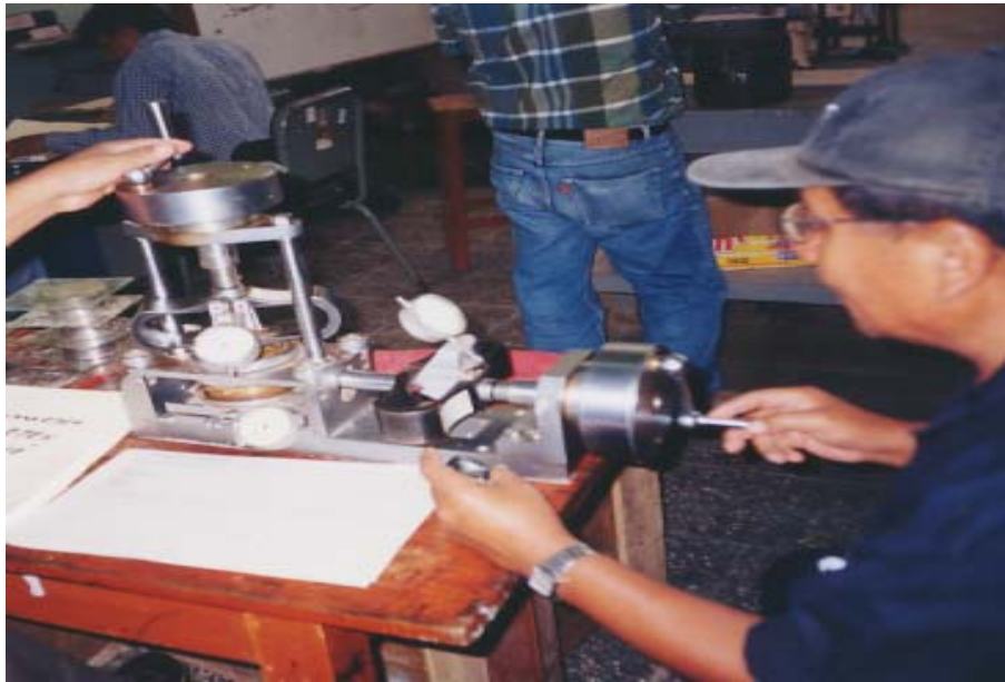
Foto Nro. E5. Ensayo de corte directo.
