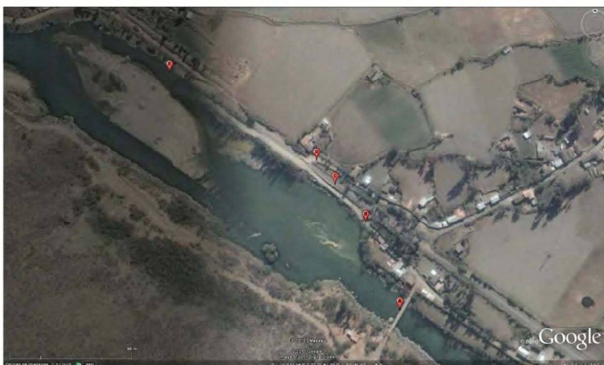
Fig. 03: Sector de Tancac Pampa. El Punto A corresponde al colapsado Puente San Pedro. Punto B: Erosión de las riveras por crecida del río. Punto C: Ubicación actual de la carretera Ollantaytambo – Piscaycucho. Punto D: Ubicación actual de la línea férrea Ollantaytambo - Aguas Calientes. Punto E: Ubicación actual de la ribera del río.
