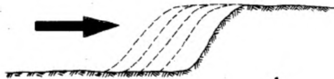
Esquema del avance de la cabeza de cárcava contra la pendiente
