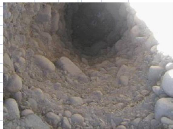
**EN ESTAS TOMAS SE OBSERVA LA EXCAVACION DE LA CALICATA C-10, UBICADA EN EL SECTOR DE ORCONA, EN DONDE NO SE OBSERVA LA PRESENCIA DE HUMEDAD**
