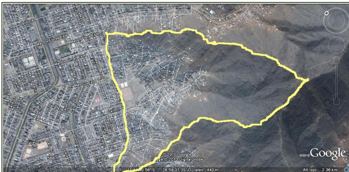
Imagen Nº 01: Ámbito del estudio comprende el área demarcada por la divisoria de agua.
