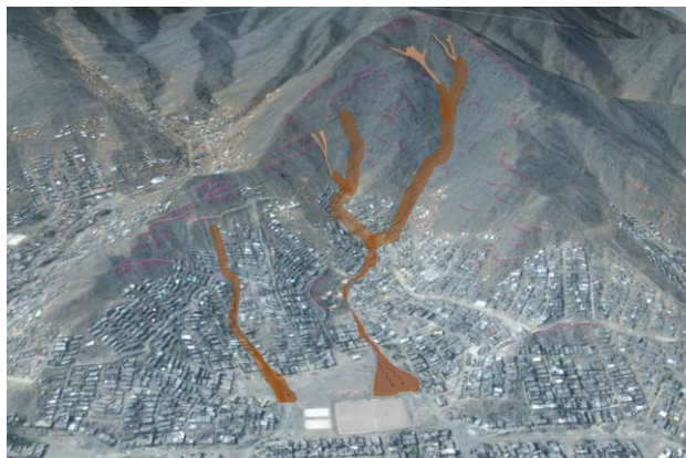
Figura N°18: Flujos de detritos que pueden reactivarse con lluvias excepcionales en el sector Virgen de Fátima. El flujo de la derecha corresponde a la quebrada Cerro Negro (Imágenes satelitales tomadas de Google Earth, 2010).
