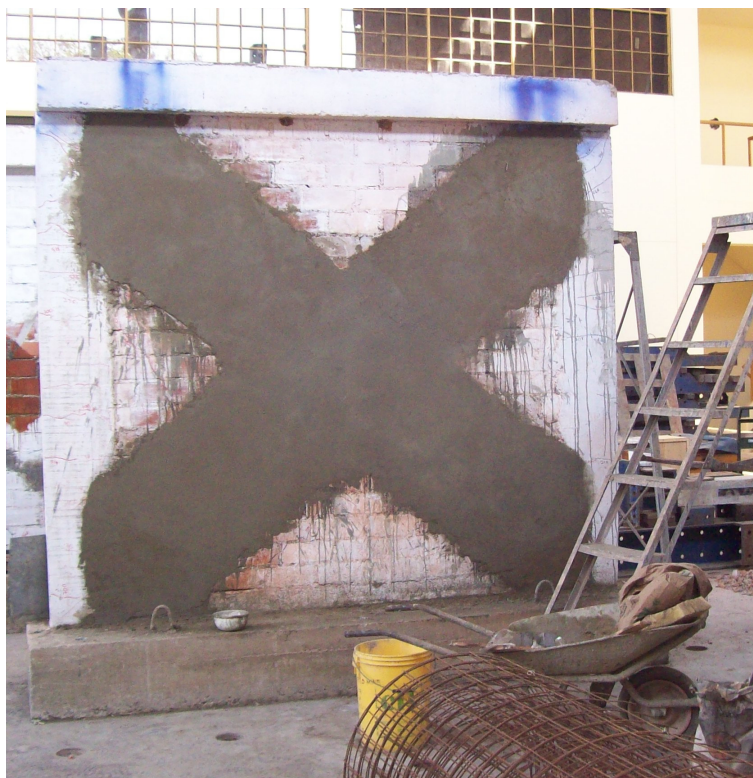
Figura 346: Reforzamiento con bandas de refuerzo.
