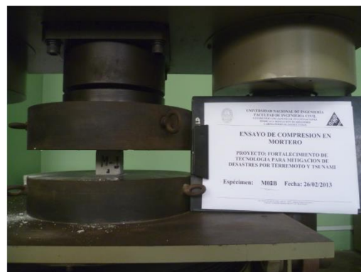
Ensayo de compresión en cubos de mortero
