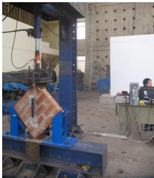
Figura 13. Ensayo de tracción diagonal
