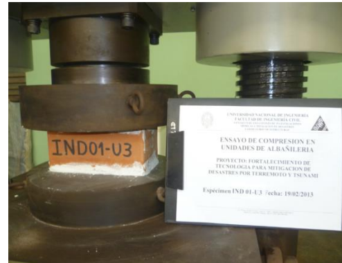
Ensayo de compresión de unidades
