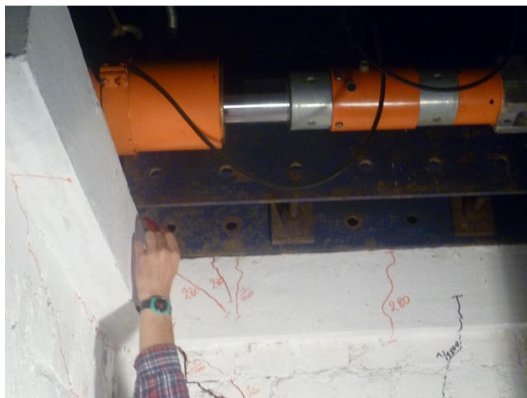
Figura 22. Aplicación de carga mediante gatos hidráulicos
