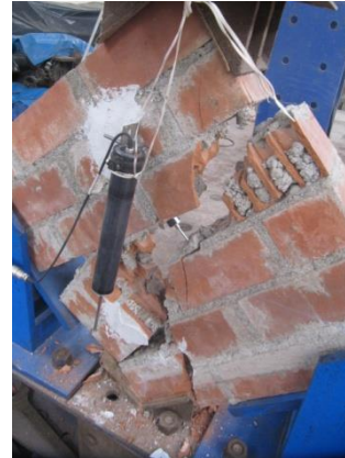
(b) tensión diagonal en juntas
