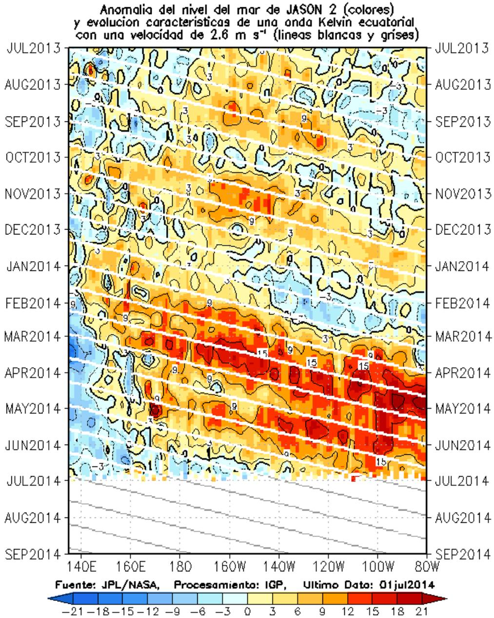
Figura 11. Diagrama longitud-tiempo de las anomalías del nivel del mar ecuatorial (cm) por el altímetro satelital JASON-2. Las líneas diagonales representan una propagación hacia el este con velocidad de 2.6 m/s. (Elaboración: IGP)
