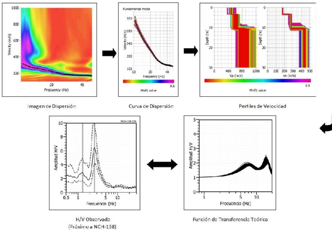
Figura 72e: Análisis e interpretación geofísica obtenida con el método MASW para el arreglo LR05-CH.
