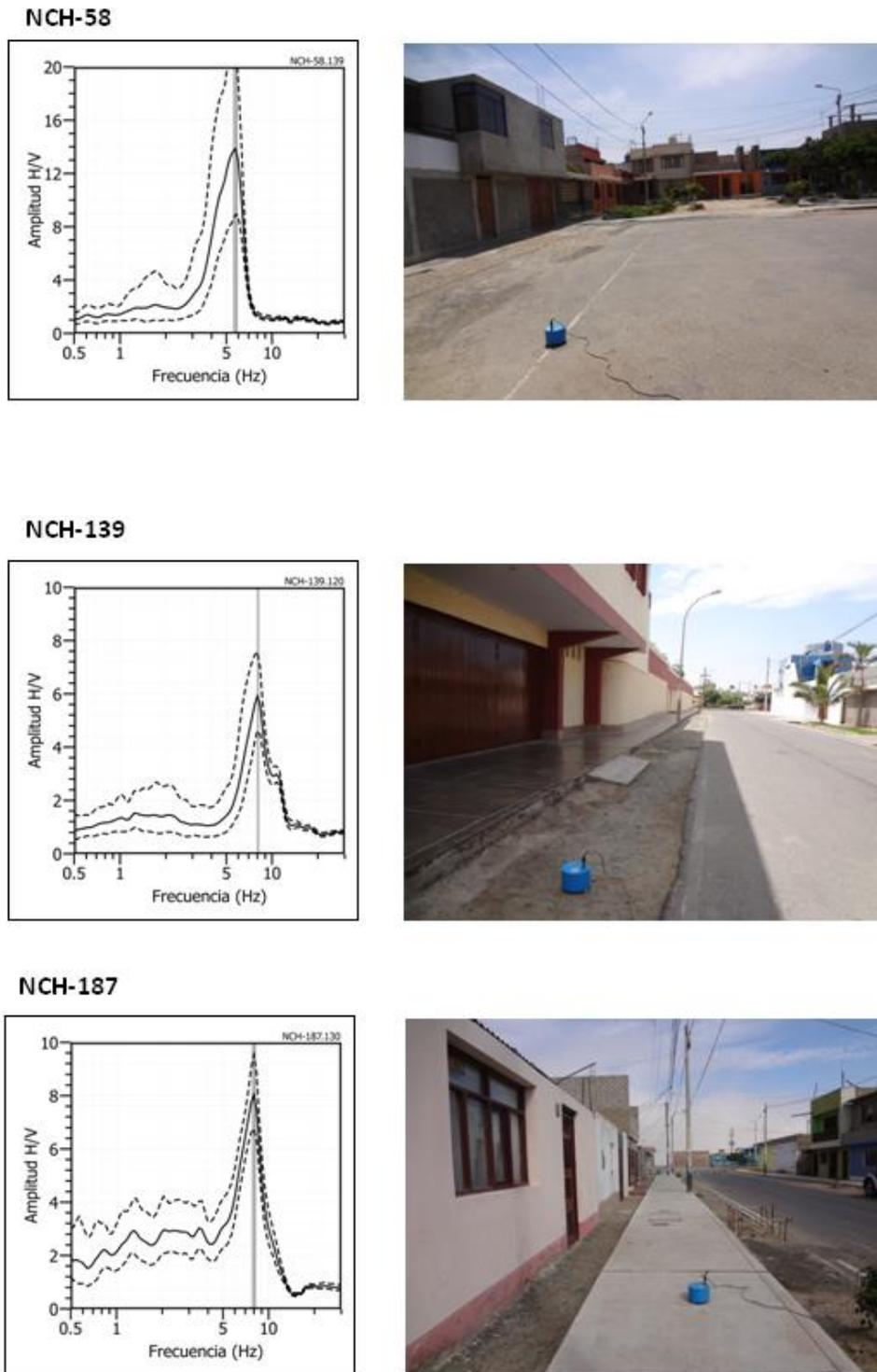
**Figura 68:** ...Continuación/ Ejemplos de razones espectrales (H/V) en el rango de las frecuencias predominantes **F1** ( $3.0 > F_p < 20\text{Hz}$ ).
