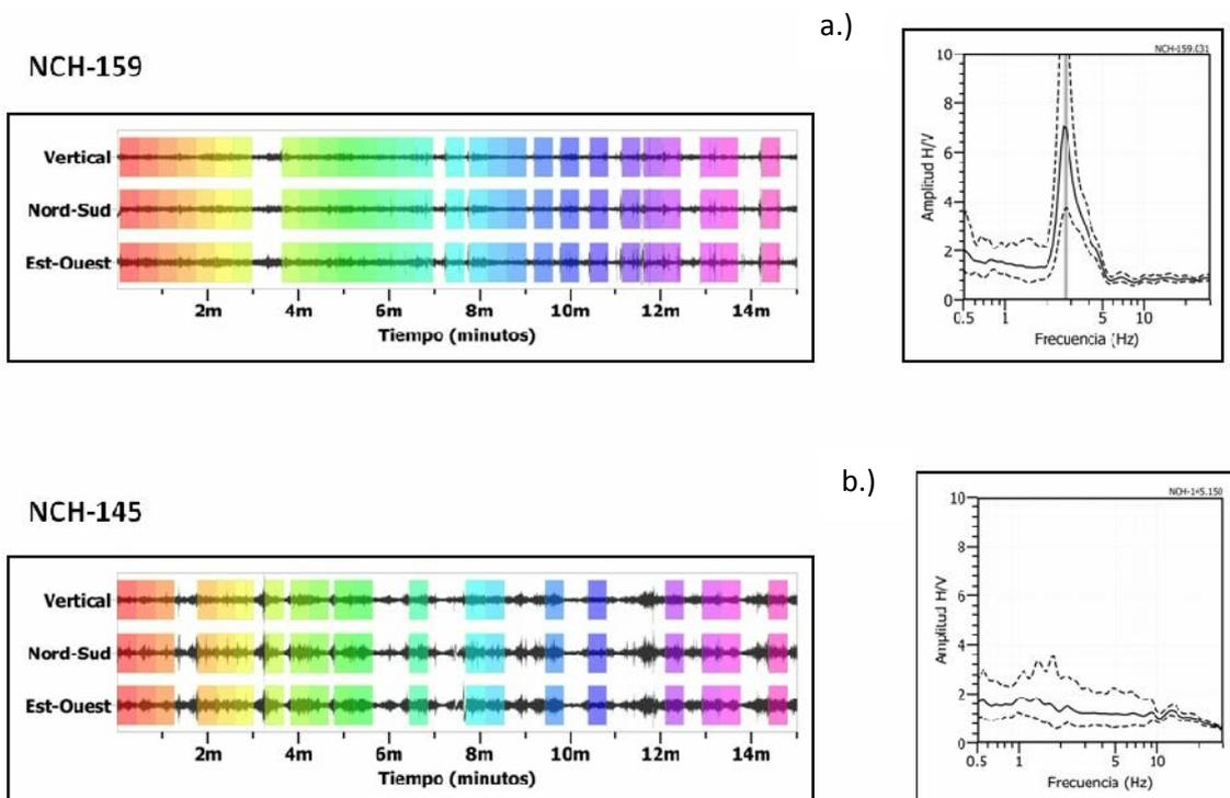
Figura 11: Ejemplo de selección de ventanas de registro de vibración ambiental (rectángulos de colores) y gráficos de H/V. **a)** Registros y razones H/V donde se identifican frecuencias predominantes, **b)** Registros y razones H/V en los cuales la frecuencia predominante presenta menor amplitud. Las líneas gruesas en los gráficos H/V indican el promedio de las curvas de razones espectrales y las líneas discontinuas su desviación estándar.
