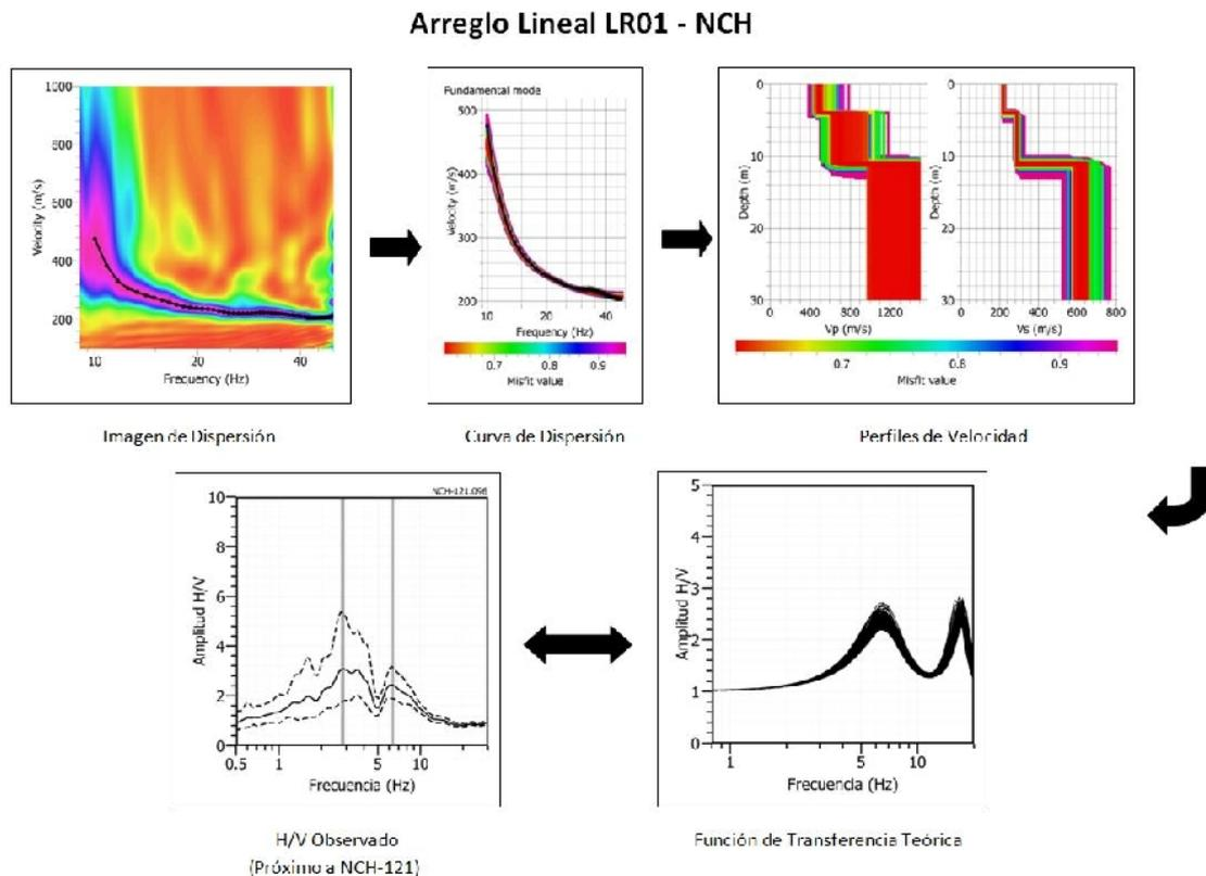
Figura 72a: Análisis e interpretación geofísica obtenida con el método MASW para el arreglo LR01-CH.
