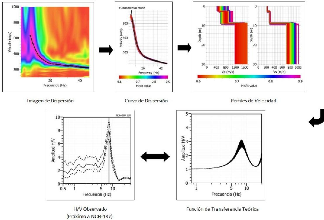
Figura 72d: Análisis e interpretación geofísica obtenida con el método MASW para el arreglo LR04-CH.
