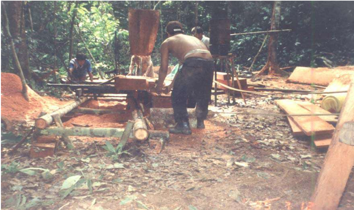
Foto 4.13.7. Aserradero portátil a disco en el sector Río Piedras
