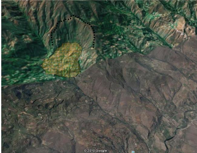
Figura 3. Imagen satelital que muestra el deslizamiento de Chinchobamba. Ejemplo típico que muestra la escarpa y depósito de un deslizamiento rotacional.
