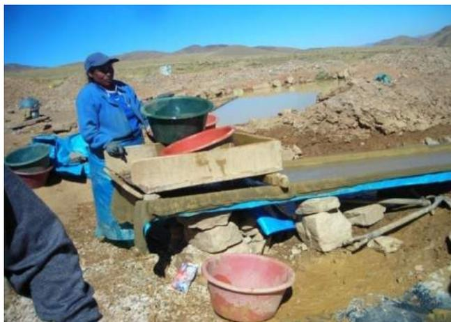
**Foto N°12:** Laboreo minero artesanal para la obtención de oro en partículas sueltas en material aluvial hechos al oeste del Centro Poblado de Cabanillas a 5000 m.s.n.m (fuente Guillen 2010).
