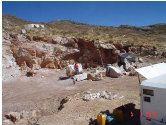
**Foto N°13:** Cantera de Travertino ubicado en Pusi – Huancane, se observa trabajo de minado para formar bloques de Travertino, en la actualidad se está trabajando, carretera Pusi - Taraco.
