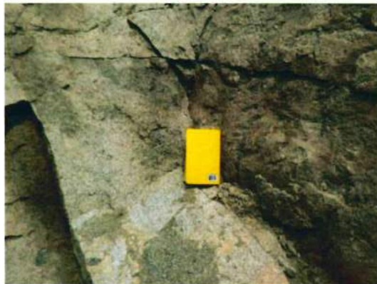
Foto 12. Roca intrusiva fracturada y medianamente meteorizada.
