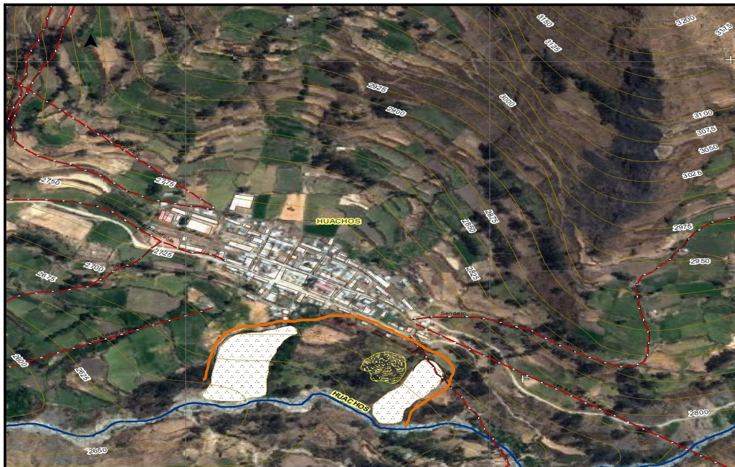
Figura 05: Deslizamiento en el cerro Manzanapata, la línea de color naranja marca la zona del cerro afectada, las áreas de color blanco indica los deslizamientos anteriores al 28-12-2013, el área de color amarillo abarca el deslizamiento actual y la línea de color rojo marca la escarpa principal.
