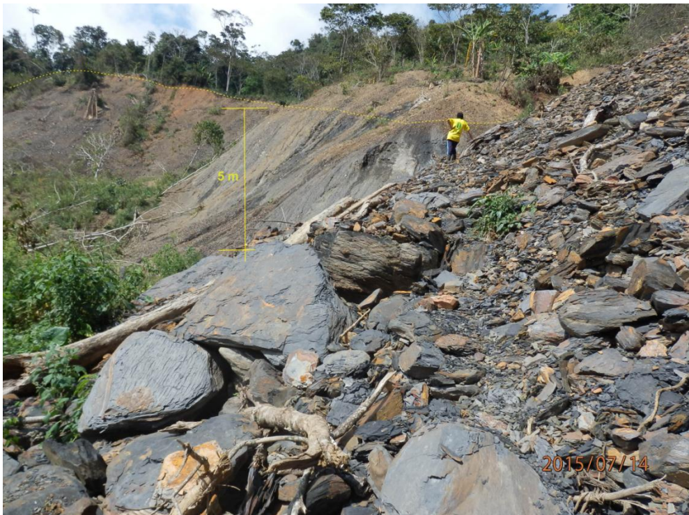
Foto 3 Vista tomada con dirección SE, donde se observa el escarpe principal con salto vertical aproximado de 5 m.
