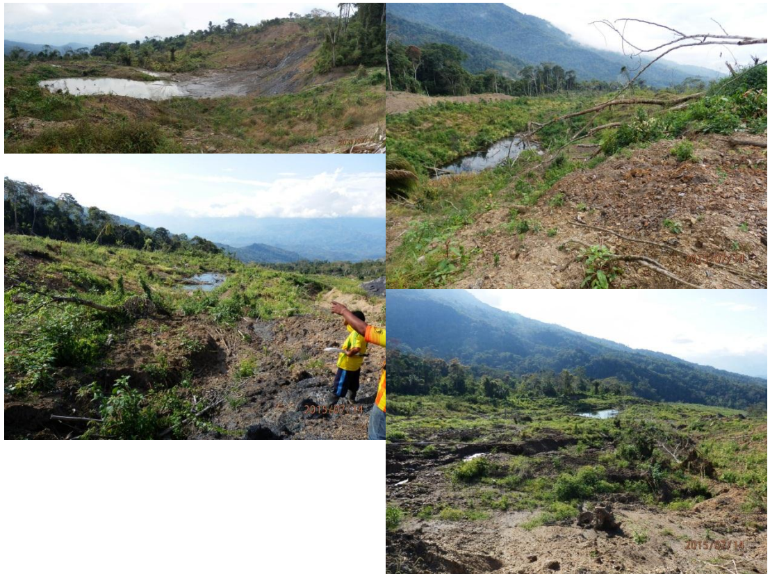
Foto 8. Vistas donde se observan cuatro puquiales formados por las filtraciones de las aguas, puquiales que se encuentran dentro del cuerpo del deslizamiento.
