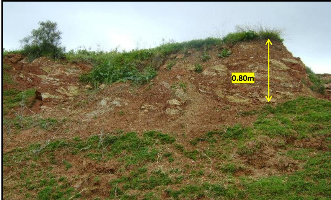
**Foto 11:** Superficie de ruptura del deslizamiento del 29-01-2014, donde se observa el predominio de matriz arcillosa-arenosa, lo que permite que el drenaje en el terreno sea lento, condición desfavorable para la estabilidad de la ladera.
