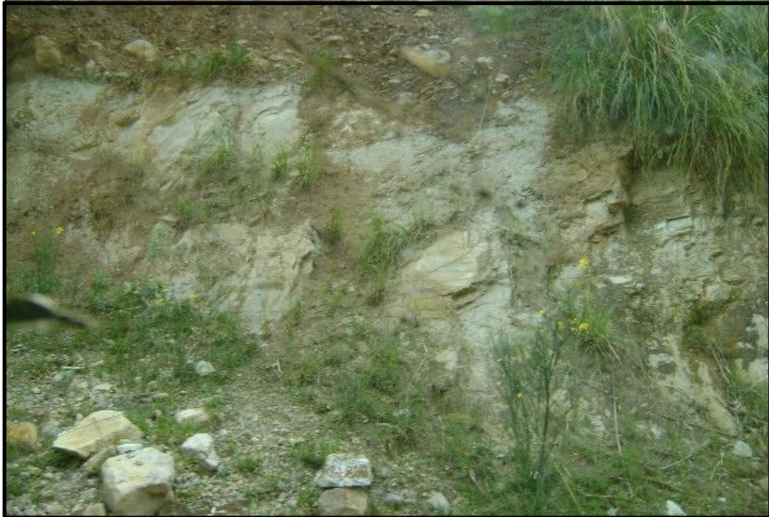
***Foto 06: Estratos de caliza de 1.5 m de espesor, presentan alto grado de fracturamiento, generando el desprendimiento de la roca, afloran en el camino de herradura que comunica a Pilchaca Viejo con el Distrito de Pilchaca.***
