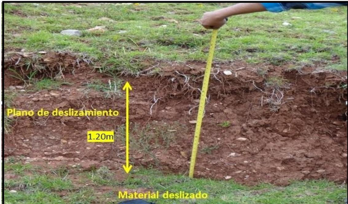
Foto 13: Superficie de ruptura, el salto de la escarpa se estima en 1.20m de longitud.
