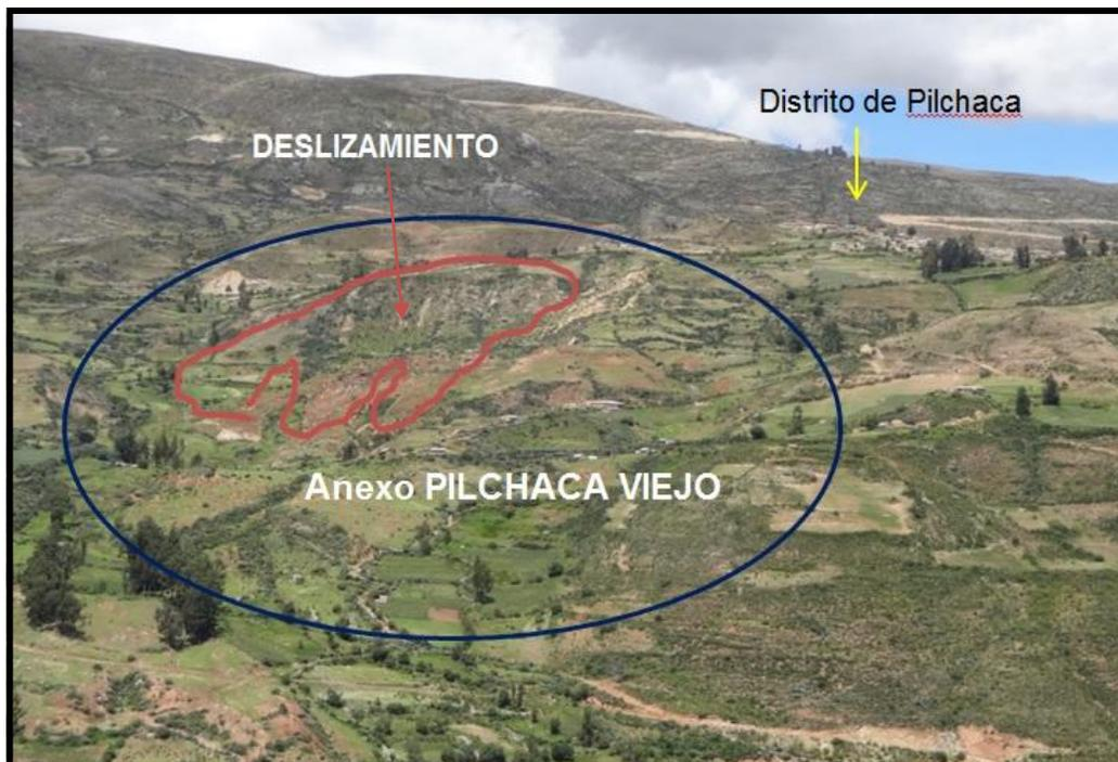
**Foto 01: El anexo Pilchaca Viejo se encuentra ubicado sobre una colina. La flecha de color amarillo indica la ubicación actual del Distrito de Pilchaca, la flecha de color rojo indica la escarpa principal y la zona de ruptura del evento. El círculo en azul abarca el anexo Pilchaca Viejo el cual actualmente se encuentra casi deshabitado.**
