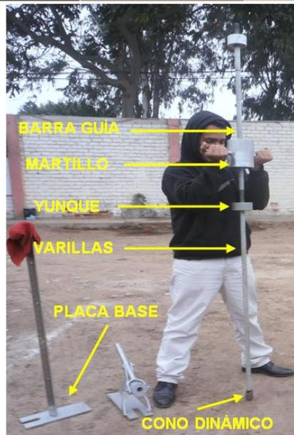
**Figura 03: Equipos y accesorios que conforman el DPL.**
