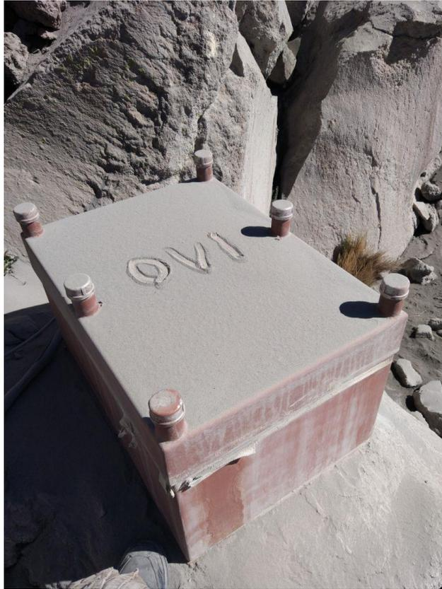
*Figura 17. Caseta metálica de la estación de monitoreo del Observatorio Vulcanológico del INGEMMET cubierta con ceniza.*
