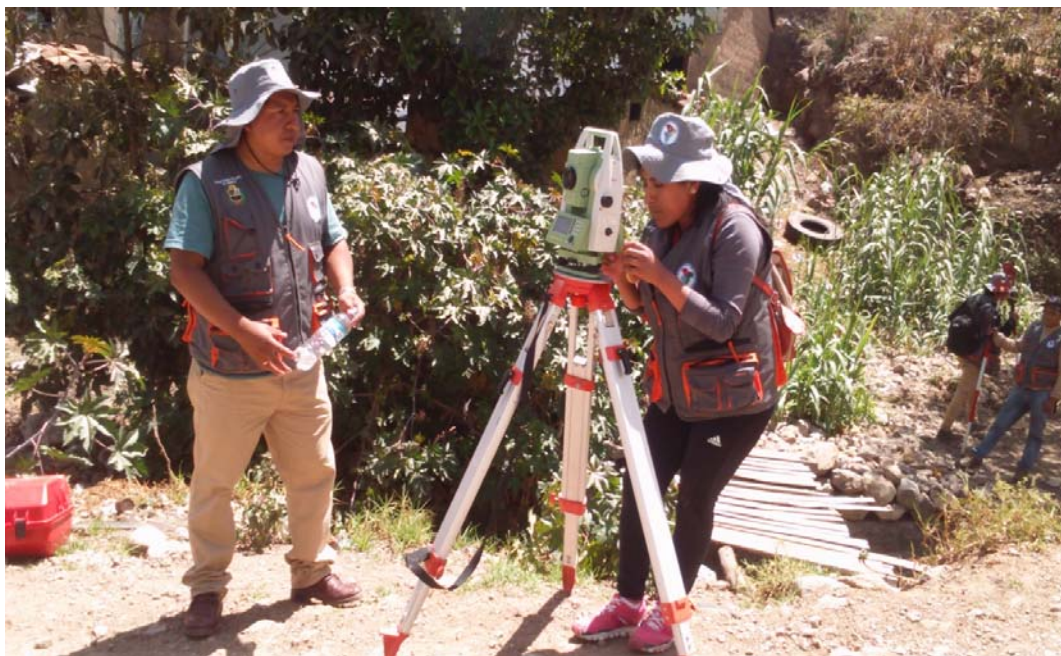
Foto N° 17: Trabajos de levantamiento topográfico
