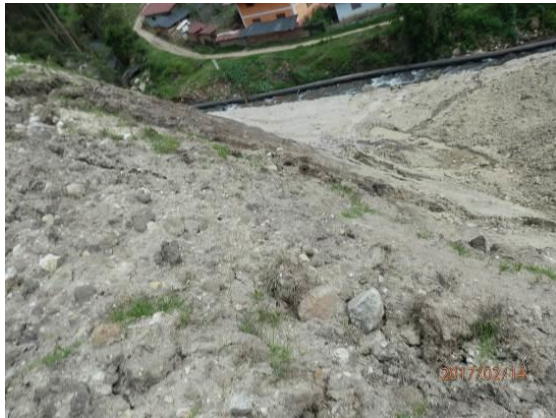
Foto 3. Vista de la parte superior del deslizamiento, se observa la escarpa principal con de 170 m. de longitud, salto vertical de 10 m.
