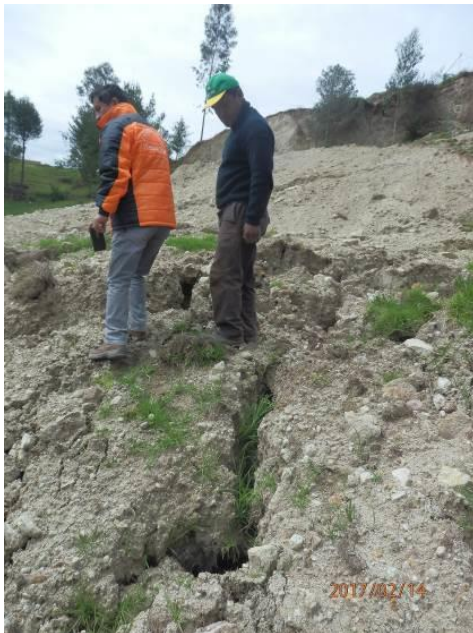
Foto 4. Vista tomada al pie del deslizamiento, se observan agrietamientos paralelos y perpendiculares que varía entre 17 a 76 m.
