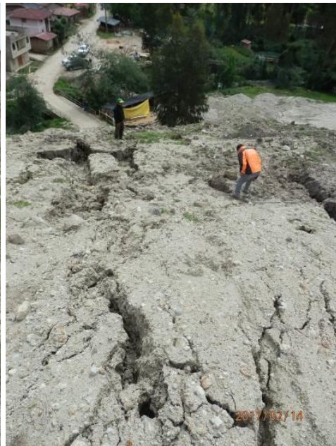
Foto 4. Vista tomada al pie del deslizamiento, se observan agrietamientos paralelos y perpendiculares que varía entre 17 a 76 m.
