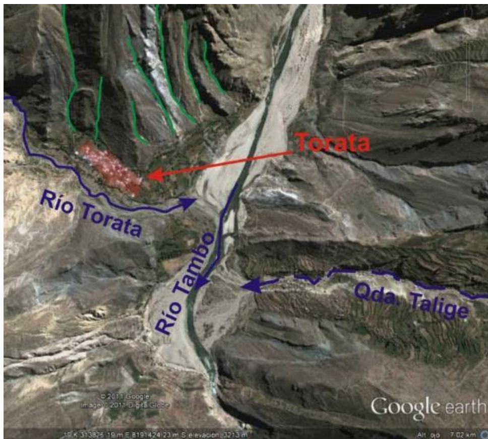
Figura 8. Sector Torata asentado en la margen izquierda del río Torata, se encuentra sobre una terraza proluvial (generados por flujos). De color verde, se muestran las erosiones de ladera. También se muestra el depósito dejado por la quebrada Talige.
