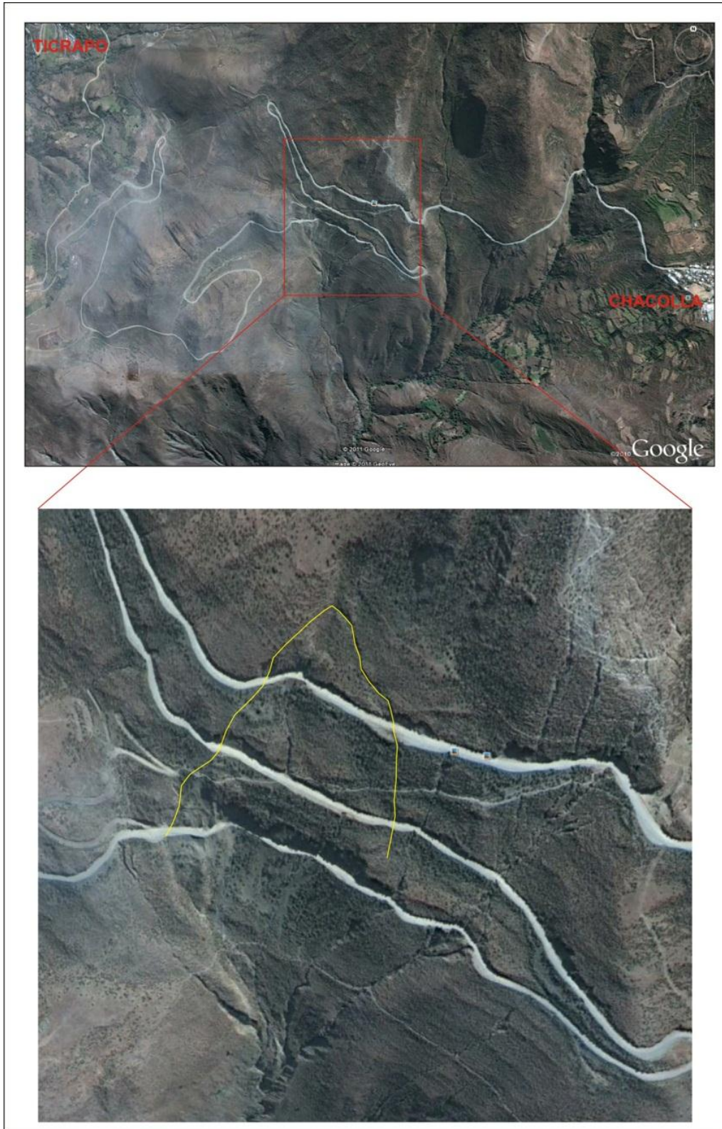
Imagen 1: Imagen Google Earth, del año 2009, donde se hace un zoom de la zona afectada por el deslizamiento traslacional (línea amarilla), en este periodo éste se manifestaba como una grieta que cortaba los tres desarrollos de carretera.
