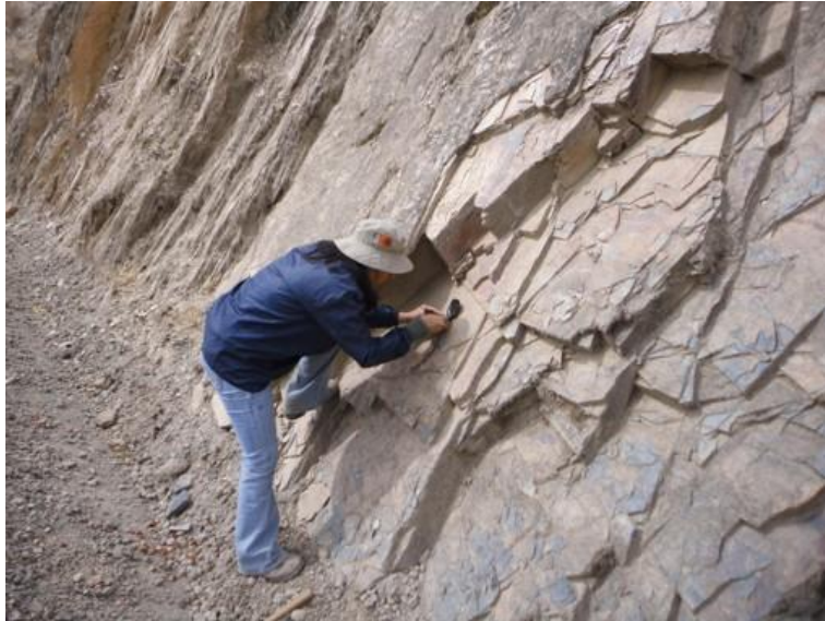
Foto 8: Inclinación de la secuencia de lutitas a favor de la pendiente de ladera.
