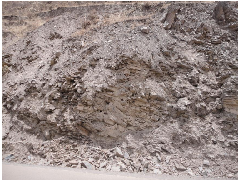
Foto 9: Vista donde se puede apreciar el grado de fracturamiento en las lutitas.
