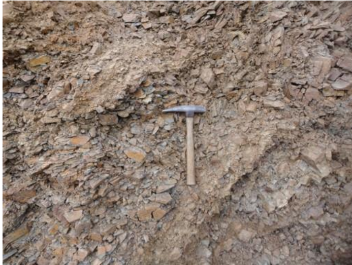
Fotos 17 y 18: Vistas donde se puede observar el grado de fracturamiento presente en las rocas areniscas y lutitas, por donde ha sido trazado la variante de carretera.
