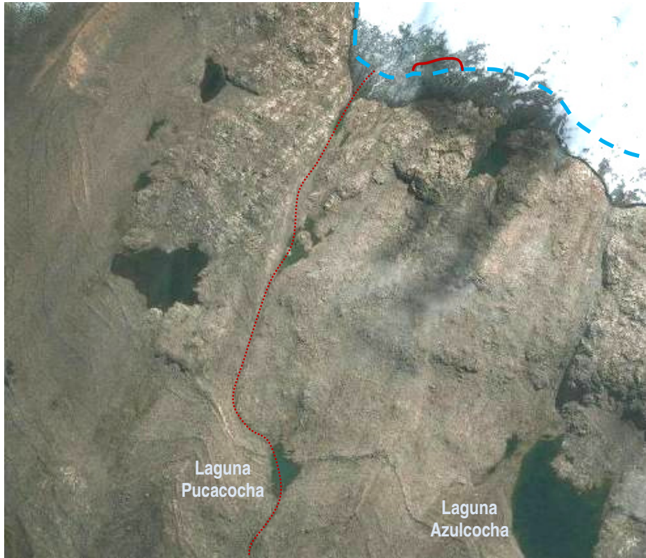
Fig. 6: Recorrido del rebalse de la laguna s/n que drenan sus aguas a la laguna Pucacocha. Imagen tomada antes del 2010 y posiblemente 2004?
