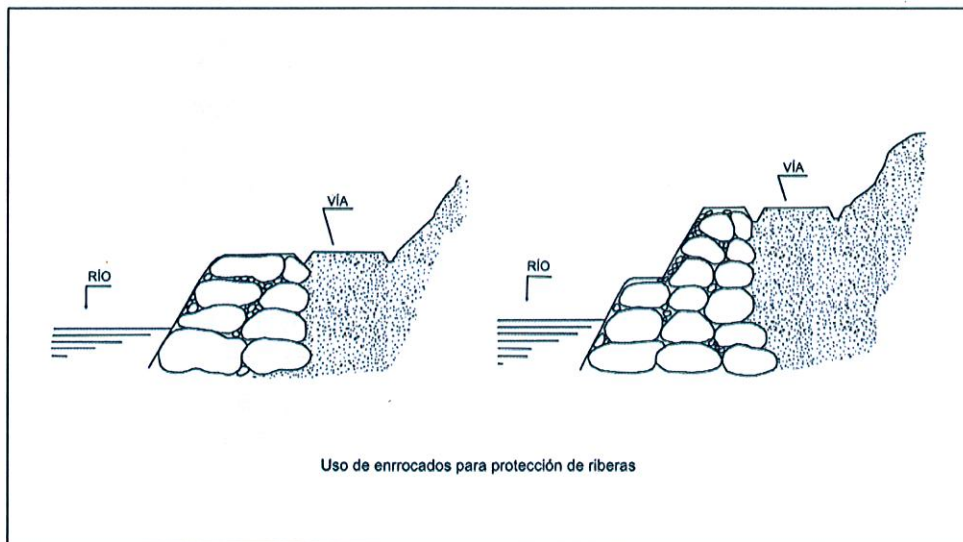
Figuras 5 y 6: Enrocados y espigones utilizados para defensas ribereñas.
