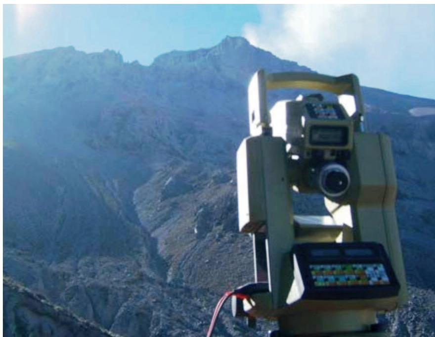
**Figura 3.64** Estación Total y Distanciómetro Laser utilizado en el monitoreo de deformación del flanco sur del volcán Ubinas.
