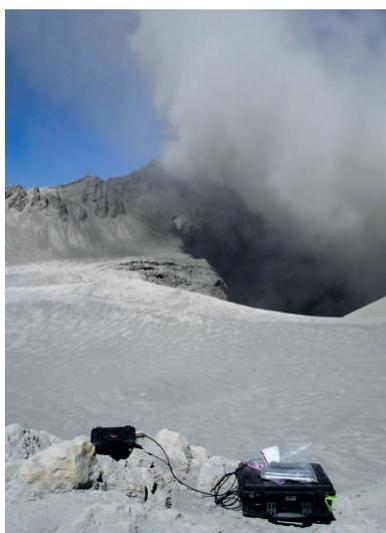
Figura 3.62 Foto del equipo Flyspec en la caldera del volcán Ubinas (Clegg, 2006).
