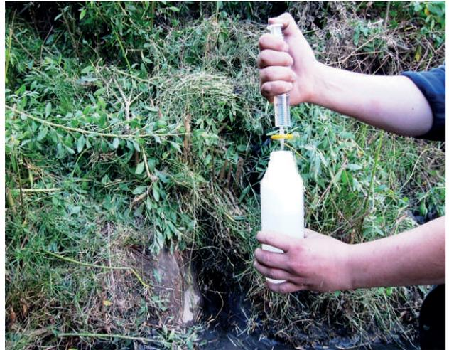
Figura 3.60 Filtrado de las muestras para el análisis de metales disueltos.
