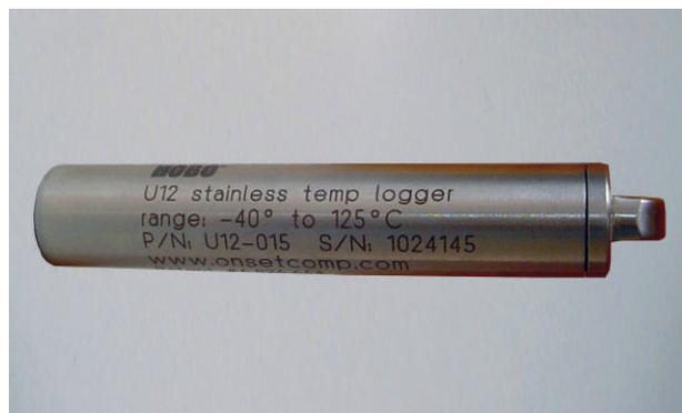
Figura 3.56 Registrador de temperatura HOBO U12-15, instalado en la estación de monitoreo Ubinas Termal.
