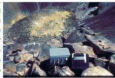
**MONITOREO GEODÉSICO:** utiliza aparatos llamados inclinómetros, que registran las deformaciones en el volcán, generalmente provocadas por la presión que ejerce el material magmático al querer salir del interior por el cráter. También se registran emisiones usando mediciones de topografía.
