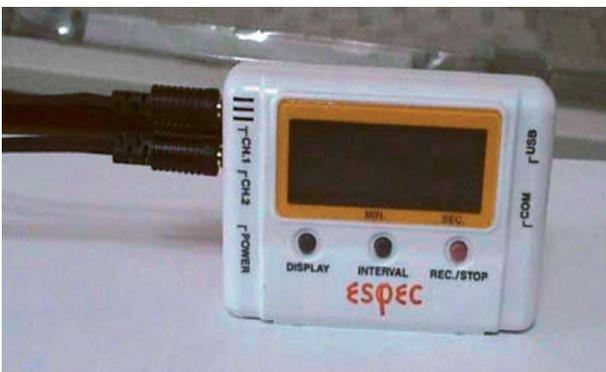
Figura 3.55 Registrador de temperatura Thermo Recorder, marca ESPEC proporcionado por la Universidad de Tokio (Japón).
