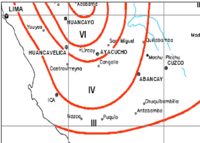
Fig. 17 – Mapa de isosistas sismo noviembre 1947 - Satipo (E. Silgado, 1948). Intensidad en Machupicchu IV.
