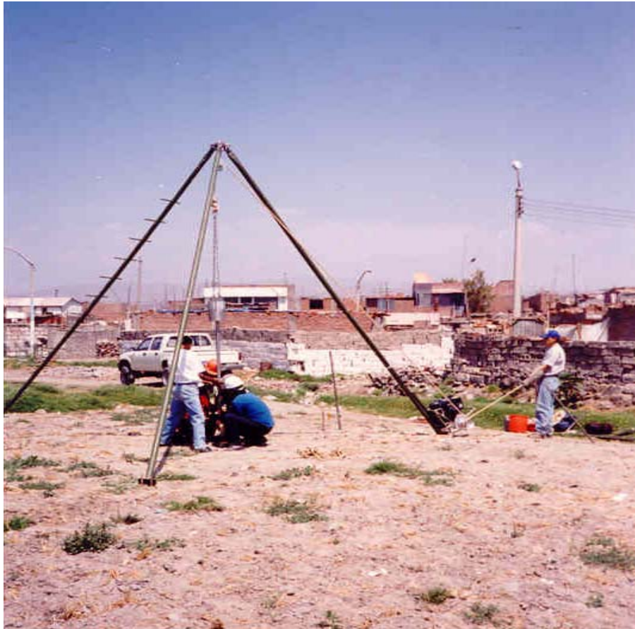
Foto 3.- Ejecución ensayos S.P.T. sector Los Cristales
