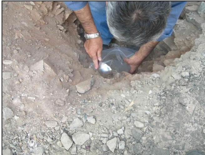
FOTO N° 51: Toma de muestras de una de las calicatas en Mollendo.
