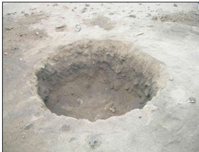
FOTO N° 50: Calicata en la zona de Mollendo, nótese el tipo de material muy superficial, el tope presenta roca fracturada.
