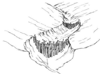
Gavión en el cuello de la cuenca Pajcha. Por el gavión se llenó el lecho del río con sedimentos, se redujo el grado y el largo de la pendiente y por consiguiente se pudo estabilizar la vegetación parcialmente reforestada. La vegetación estabiliza los sedimentos y remplazó el objetivo de la pared después de pocos años.
