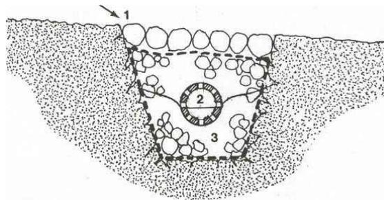
Figura 2.2.2: 1.- Alimentación superficial, 2.- Tubería perforada de rebase, 3.- Relleno.
