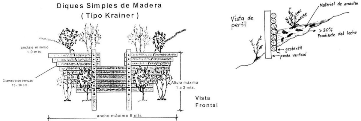
Vista de perfil de un dique de madera tipo Krainer. La pendiente del lecho se reduce de  $30^\circ$  a  $18^\circ$ . Después de haberse llenado el dique con sedimentos, se planta los arbustos/árboles
