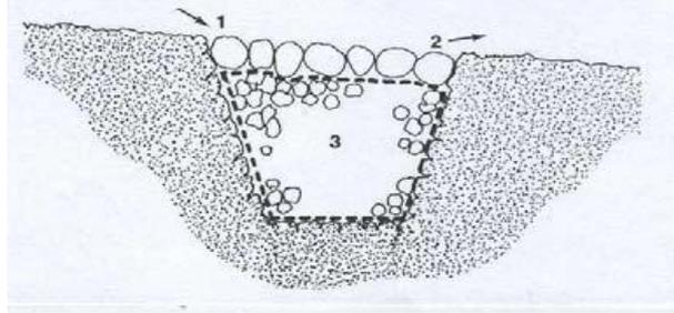
Figura 2.2.1: 1.- Alimentación superficial, 2.- Rebase, 3.- Relleno
