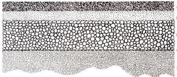
Figura .2.3.2: Elementos de un pavimento poroso:
