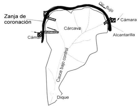
Vista de perfil a una zanja de coronación. Solamente en la parte inferior se construye una Barrera Viva. El ancho y el largo de la zanja es de 0.3 mts. Hay que colocar la cámara de desagüe de forma que el agua en la zanja no puede desbordar (el agua queda 5 - 10 cm bajo el nivel de desborde de la zanja).
