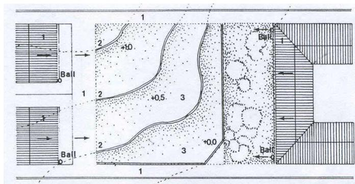
Figura 2.1.3: Estanques de infiltración en zonas con pendiente usando solerillas en las curvas de nivel.
