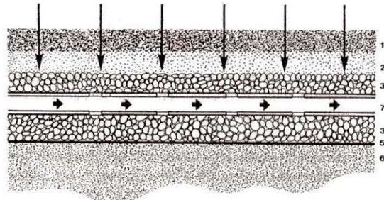
Figura 2.3.4: Disposición concentrada aparte. El agua que ingresa a la sub base se drena con tubos hacia afuera.
