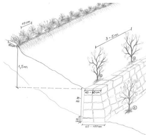
Vista de perfil a un Muro de Piedras. La pendiente por la formación de la terraza se reduce del 30° a 18°. El muro alcanza un alto de hasta 1 m. El grosor en la base es de 0.6 hasta 1 m. El grosor del muro en la parte alta alcanza 0.4 hasta 0.6 mts. Se excava alrededor de 0.2 m de tierra para que el muro este firme en el suelo.
