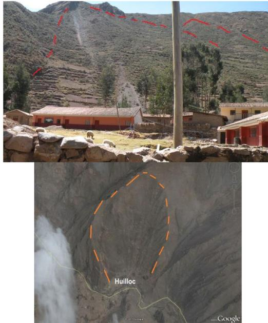
Vista del deslizamiento de Huilloc desde la carretera e imagen de foto satelital de este mismo deslizamiento antiguo se observa escaso material con respecto al volumen deslizado.
