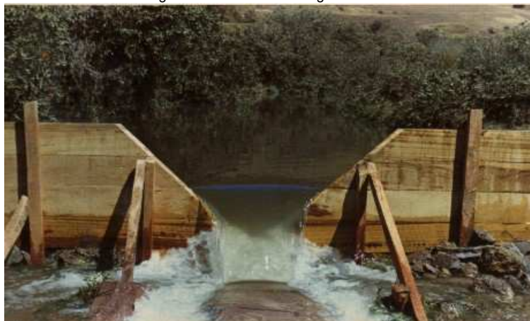
Figura N° 44 Vertedor triangular de 90°
