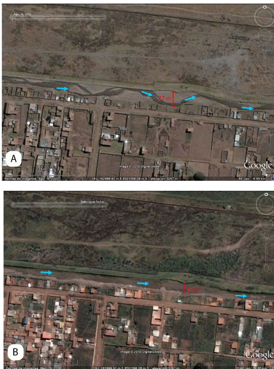
Fig. 9: En la figura se muestra una comparación a partir de imágenes Google Earth del 2002 (A) y 2010 (B) del sector APV. San Antonio. En estas se observan que el cauce del río Huatanay varió de 27 m (2002) a 16 m (2010).
