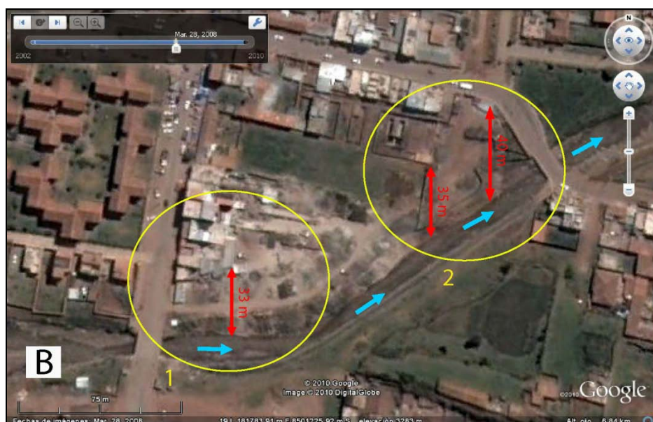
Fig. 4: En la figura mostramos una comparación entre imágenes Google Earth del 2002 (A) y 2008 (B) del sector Puente Agua Buena – Av. Pachacamac. En estas se observan las variaciones del cauce del río Huatanay debido a las actividades del hombre.
