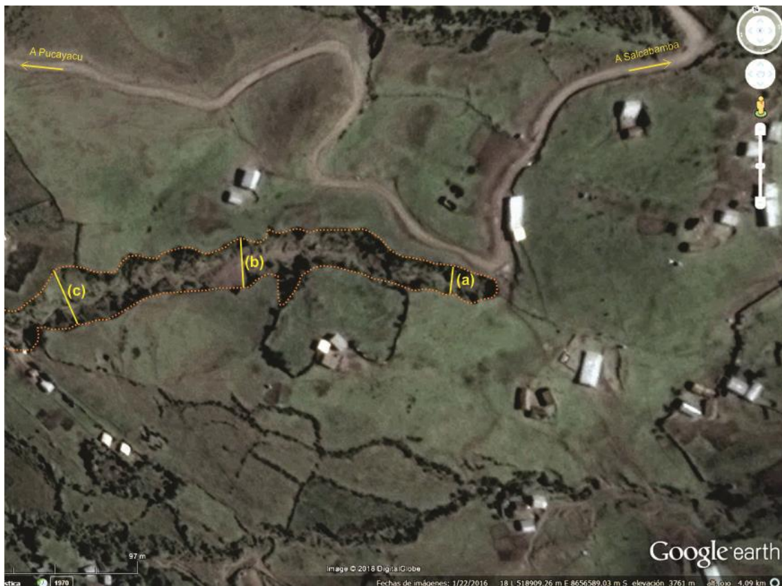
Figura 4. Proceso de erosión en cárcavas, muestran anchos variables: (a): 10 m; (b): 20 m; (c): 30 m.
