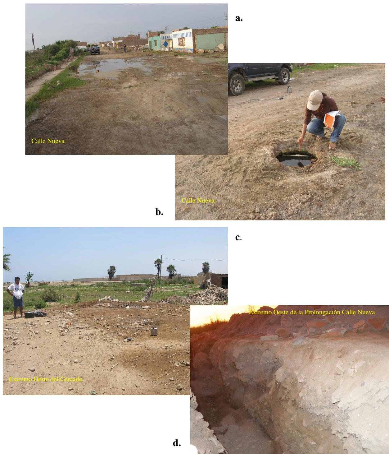
**Figura 4.** Fotos representantes del AREA1. a) y b) En algunas zonas existen afloramientos del nivel freático. c) Zonas de relleno y d) Se muestra una zanja de medio metro de profundidad. Nótese la presencia de humedad.
