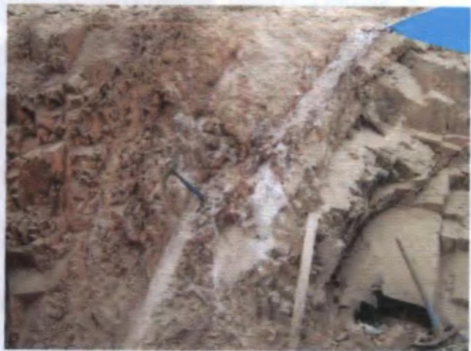
Foto N° 4 y 5. Obsérvese el fracturamiento y alteración de la roca producto de diaclasas y falla local, e incluso la diferencia de colores de la roca en la foto N°5
