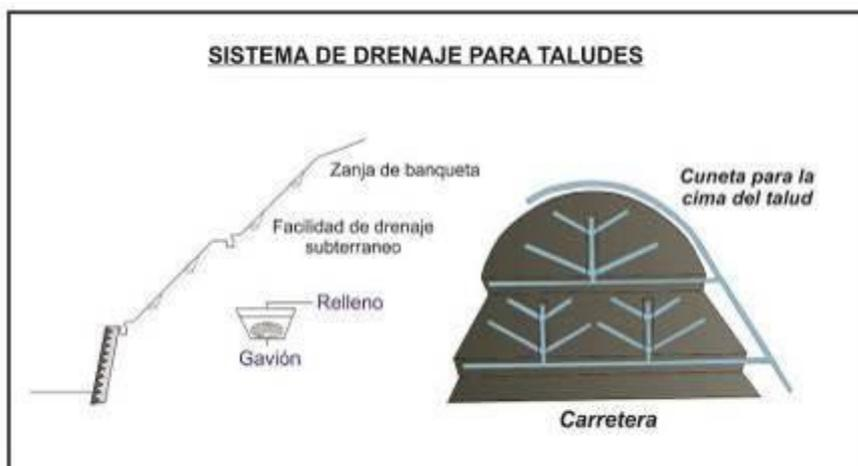
**Figura 7.** Sistema de drenaje tipo espina de pez.
