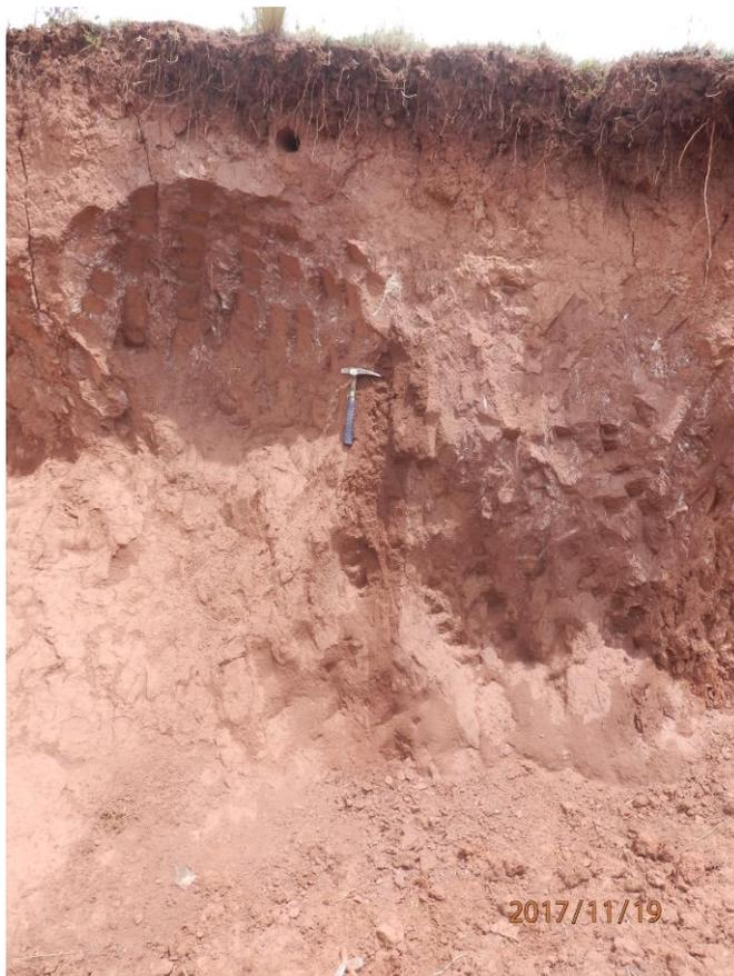
**Fotografía 1**, Vista tomada con dirección noroeste, se observa deposito coluvial formado por material limo arcillosa (coordenadas 240903 E; 8427250 S)
