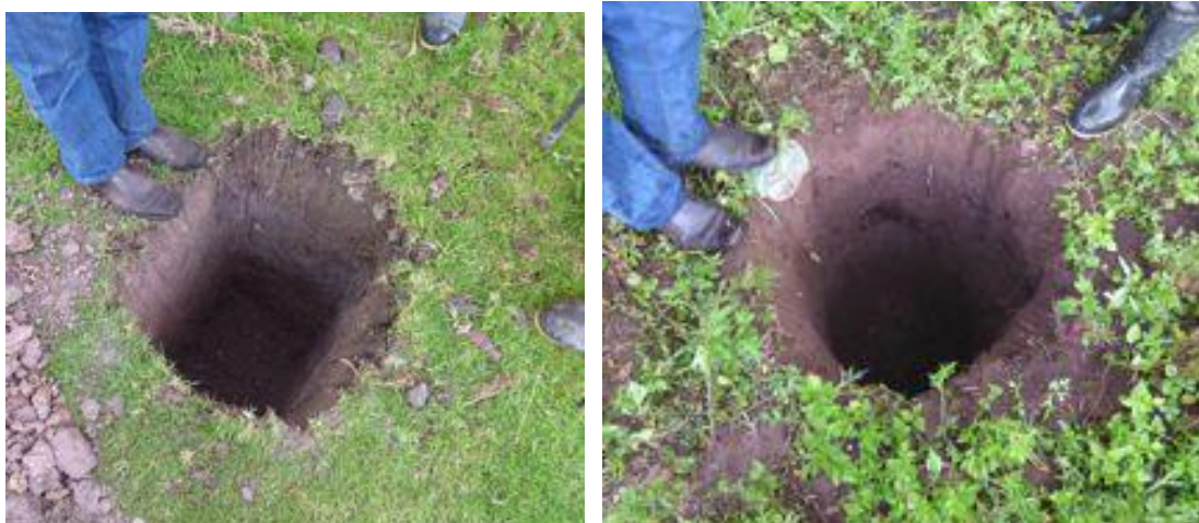
Fotos 13 y 14. Calicatas, muestran suelos de color marrón con tonalidades rojizas.
