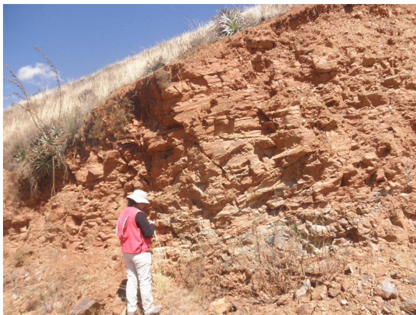
Foto 2. Afloramiento muy fracturado de limoarcillitas (514358E-8628405N)
