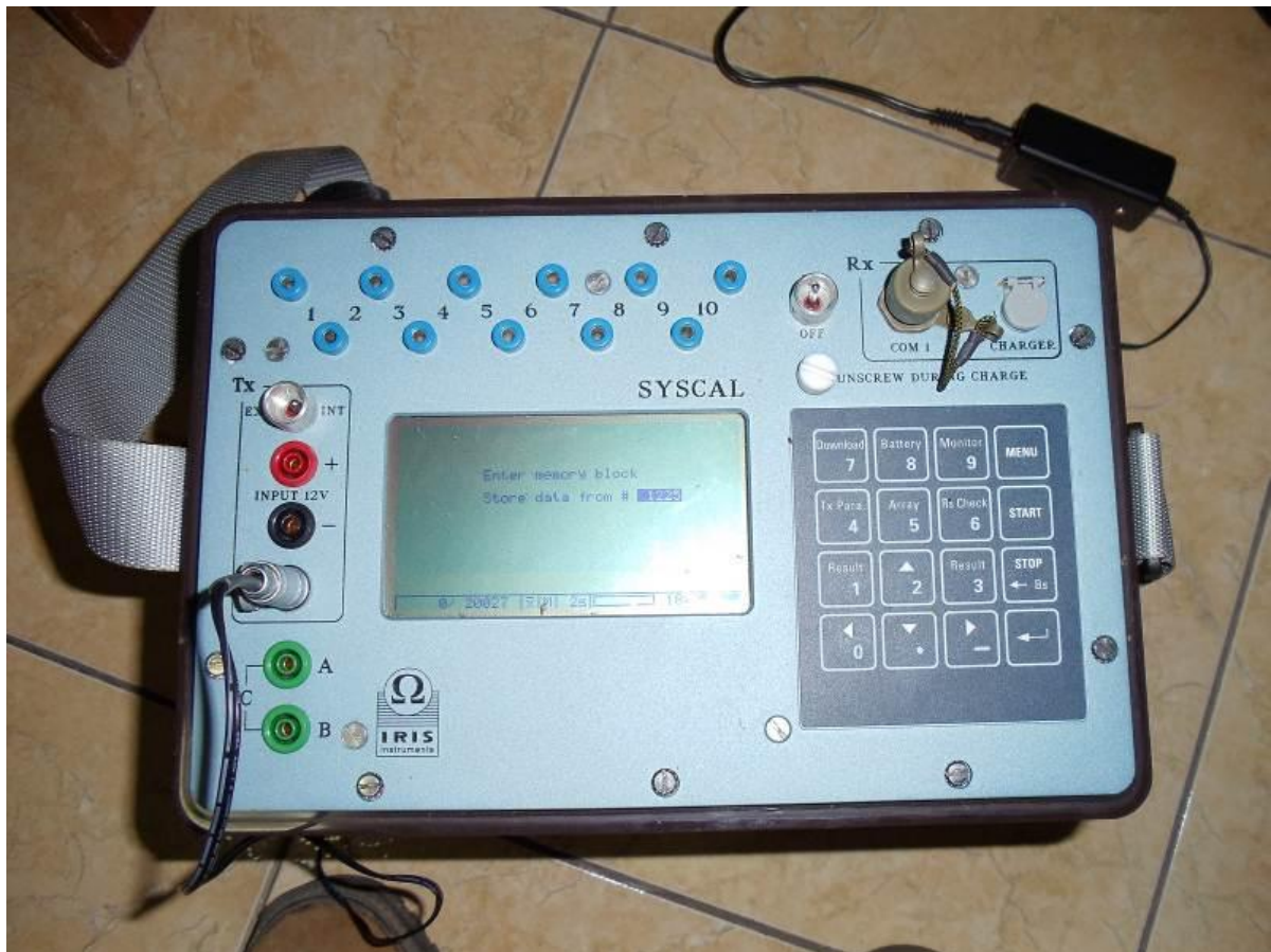
Foto 10. Se aprecia al Equipo Psyscal Pro 48 Swicht –Geoinstrumens Iris utilizado en el área de trabajo- AAHH. 9 de Octubre – El Agustino.
