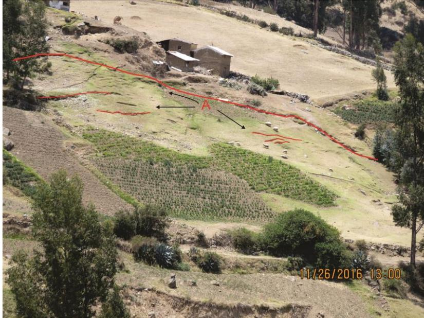
Foto 4 Vista tomada con dirección oeste, se observan agrietamiento en el terreno (línea de color rojo)
