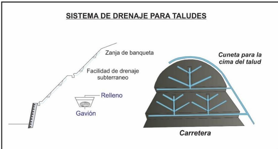
**Figura 5.** Se observa un sistema de drenaje para taludes. (Sosa, N., 2017)
